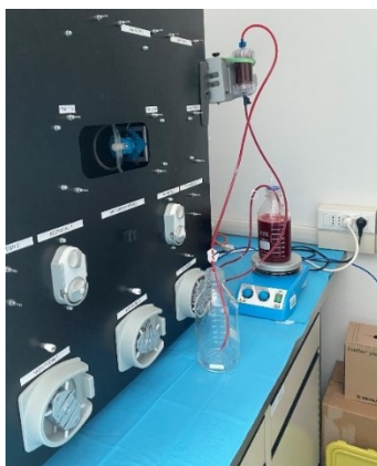
Figura 4.30: Esecuzione del Single-Pass. Tutta la soluzione viene fatta passare una volta attraverso il mini-modulo.
