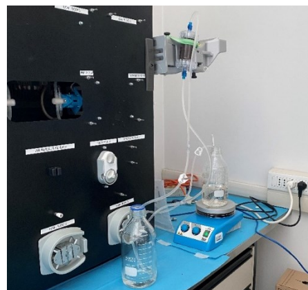
Figura 4.22: Primo passaggio della soluzione antibiotica attraverso il mini-modulo. Si esegue il Single-Pass.
