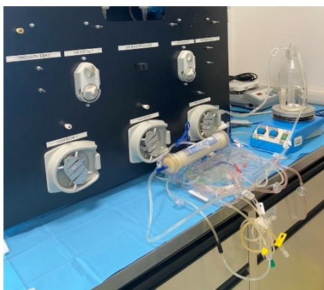
Figura 4.34: Set-up sperimentale della prova con il filtro oXiris. Si osserva come la linea di inflow e outflow del filtro sono state poste all'interno del reservoir, mentre lo spezzone pompa all'interno dell'alloggiamento della piattaforma.
