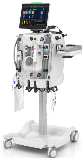
Figura 2.1: Esempio di sistema per la terapia di purificazione extracorporea: PrismaX (Baxter).
