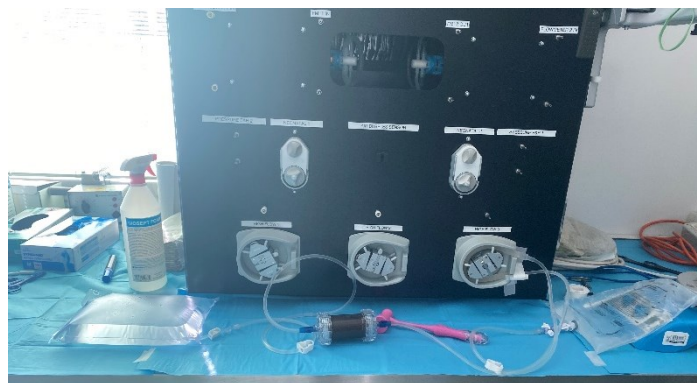
Figura 4.17: Preparazione del materiale utilizzato per effettuare il priming del circuito. A destra si osserva la sacca di fisiologica da cui prelevare la soluzione e a sinistra la sacca di scarico.
