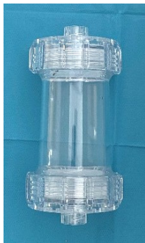
Figura 4.1: Aspetto del mini-modulo vuoto, da riempire con 75 gr di beads.
