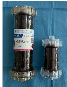
Figura 4.2: A sinistra, cartuccia Jafron HA380; a destra, mini-modulo riempito con 75 gr di beads.
