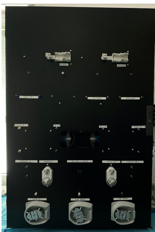
Figura 4.4: La piattaforma sperimentale Galileo impiegata per simulare una macchina per CRRT. Nella parte inferiore della piattaforma si possono osservare le pompe peristaltiche utilizzate durante i vari esperimenti.
