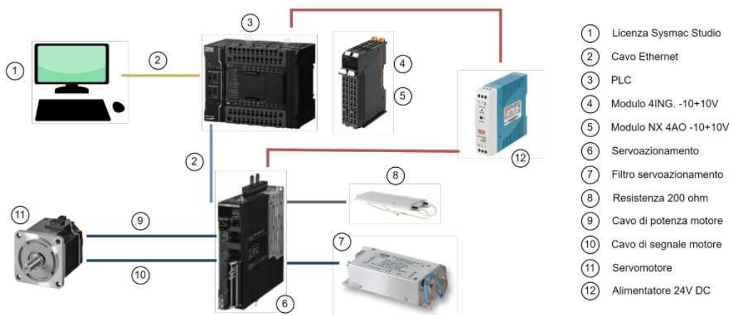
Figura 3.6: Schema del set-up elettrico
