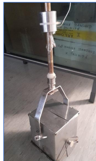
Figura 10: : Benna utilizzata per la raccolta del sedimento.
