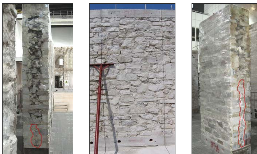
Fig 2.13: Pannello 3T. Rilievo pre-prova: sezione B-B' sx, prospetto frontale, sezione A-A' dx. L'area iniettata è indicata con una polilinea rossa.
