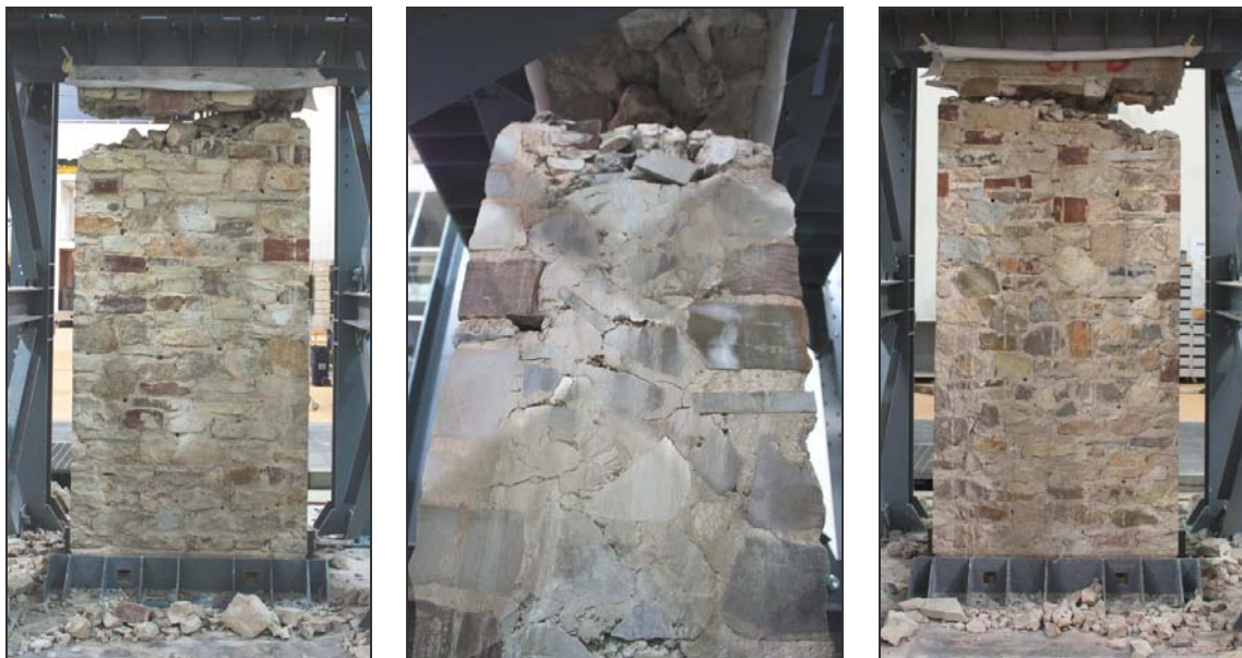
Fig 3.45: Pannello 6I. Rilievo fotografico del collasso, 0.75g (fronte-sezione B-B'-retro).
