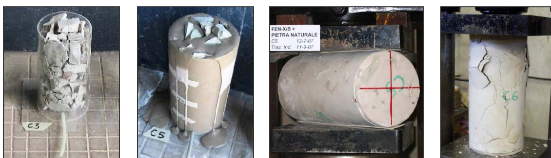
Fig 2.9: Preparazione del provino e prove a trazione indiretta e a compressione. [Mazzon, 2010]
