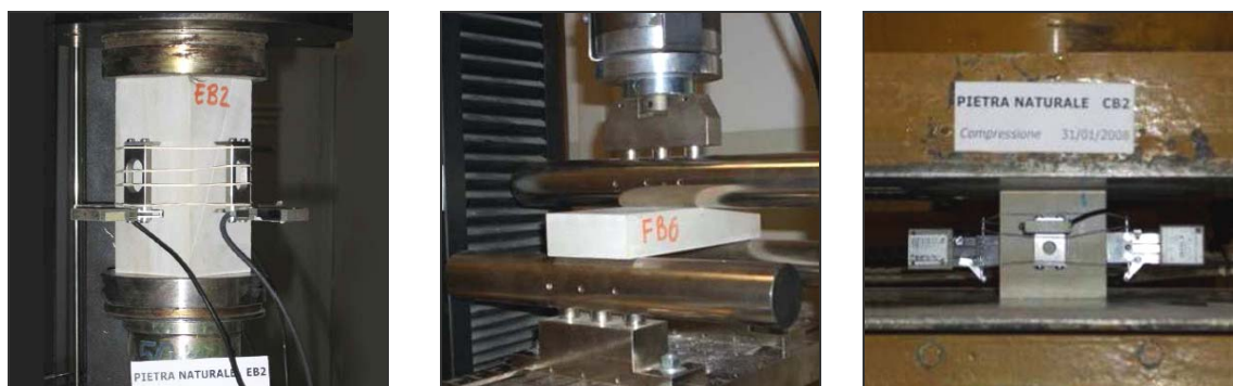
Fig 2.7. Determinazione del Modulo Elastico e della Resistenza a flessione e a compressione nei provini di pietra calcarea di Cugnano (BL). [Mazzon, 2010]
