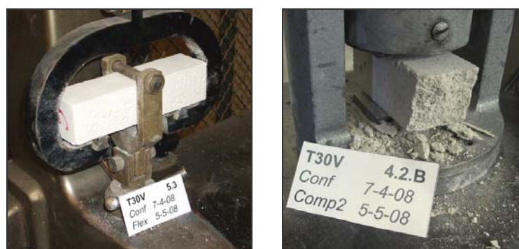
Fig 2.6: Prove a flessione e a compressione sui provini di malta T30V. [Mazzon, 2010]
