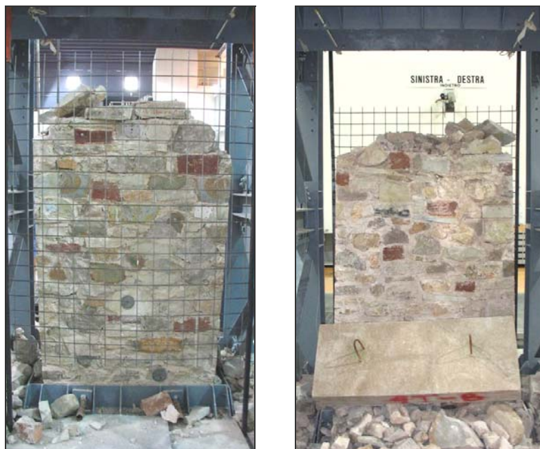
Fig 3.29: Pannello 4T. Rilievo fotografico del collasso, 0.45g (fronte e retro).
