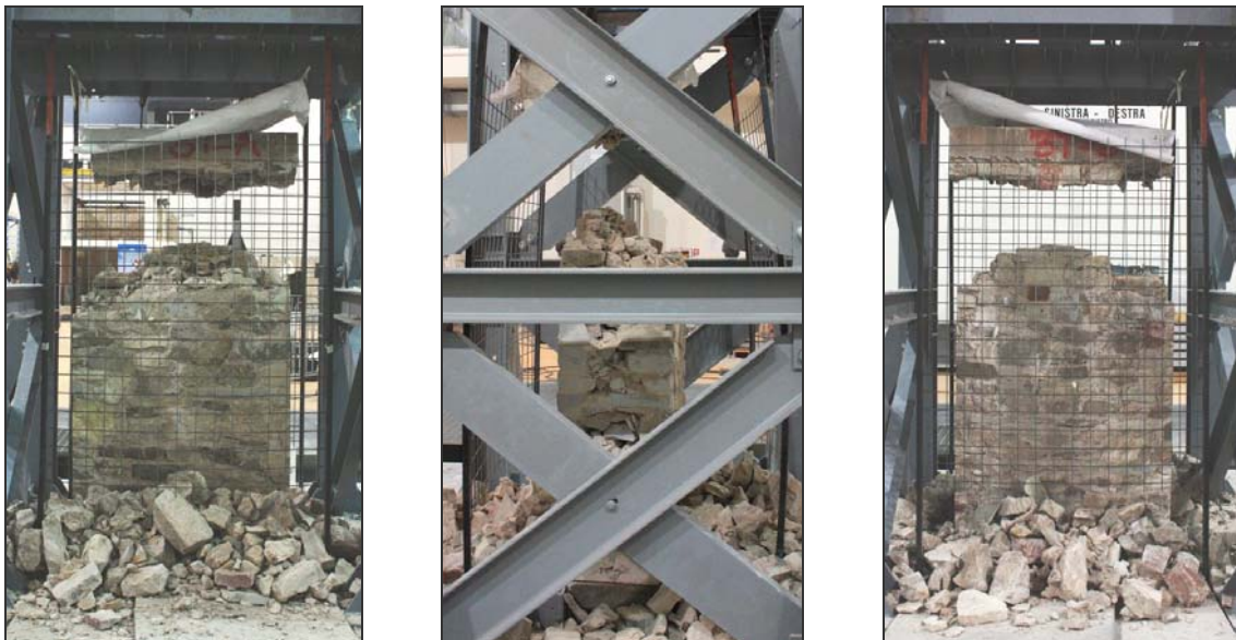
Fig 3.20: Pannello 3T. Rilievo fotografico effettuato in seguito alla seconda prova a 0.60g.
