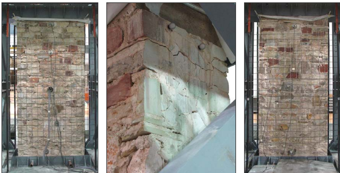
Fig 3.60: Pannello 8IT. Rilievo fotografico a prova conclusa, 0.75g (fronte-sezione B-B'-retro).
