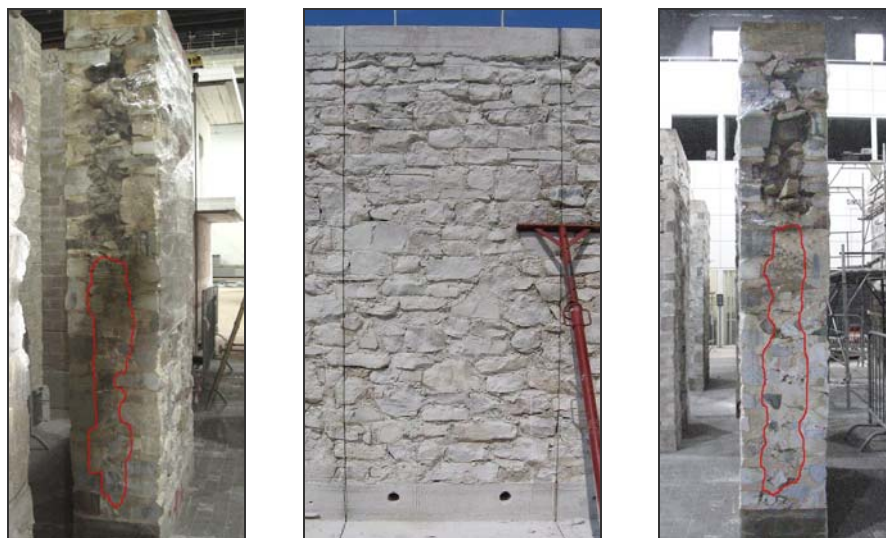
Fig 2.14: Pannello 4T. Rilievo pre-prova: sezione B-B' sx, prospetto frontale, sezione A-A' dx. L'area iniettata è indicata con una polilinea rossa.
