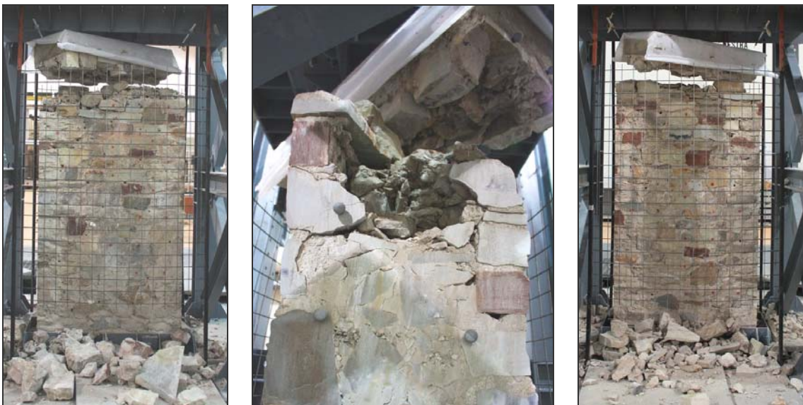
Fig 3.38: Pannello 5I. Rilievo fotografico del collasso, 0.55g (fronte-sezione B-B'-retro).
