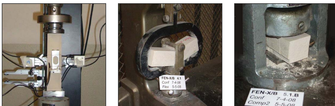
Fig 2.8: Determinazione del Modulo Elastico e della Resistenza a flessione e a compressione nei provini di malta per iniezione FEN-X/b. [Mazzon, 2010]
