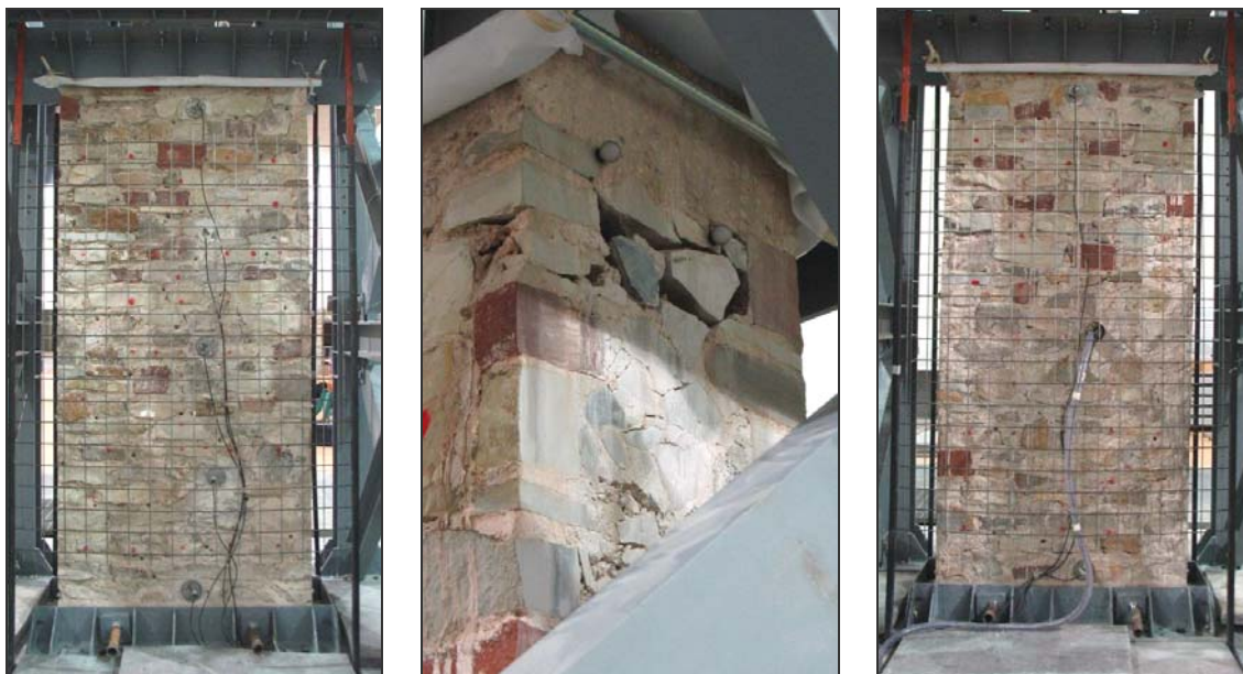
Fig 3.52: Pannello 7IT. Rilievo fotografico a prova conclusa, 0.75g (fronte-sezione B-B'-retro).
