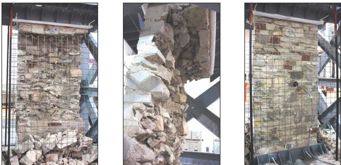
Fig 3.4: Pannello 1-URM. Rilievo fotografico del collasso, 0.35g (fronte-sezione B-B'-retro).
