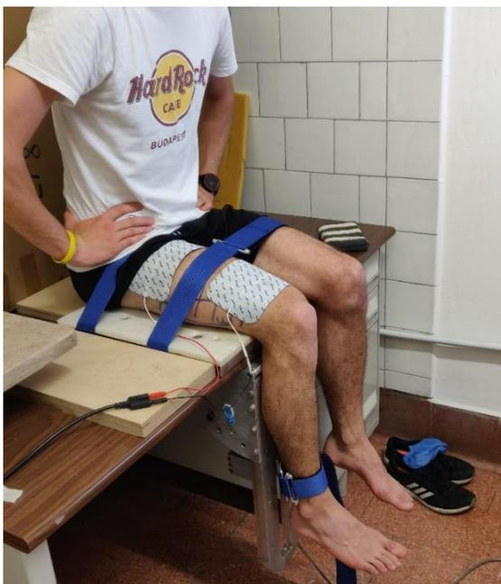
*Fig. 5.2: L'impostazione dell'attrezzatura per l'MVC su un soggetto della ricerca. Si possono osservare gli elettrodi per la stimolazione, il dinamometro e i relativi vincoli articolari.*
