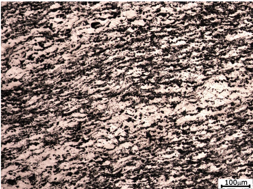
Figura 4.2.8: sezione del coating, fasce ricche di rame e fasce ricche di allumina
