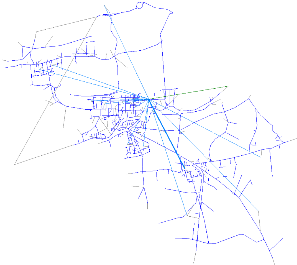
Figura 3-27: linee dei desiderio per il periodo di punta della sera; in verde: gli spostamenti attratti dalla zona del centro di Dolo con i maggiori edifici scolastici, in blu: gli spostamenti generati
