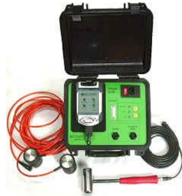
Figura 4.1: Strumentazione per prova sonica. Centralina, martello strumentato e ricevitori.
