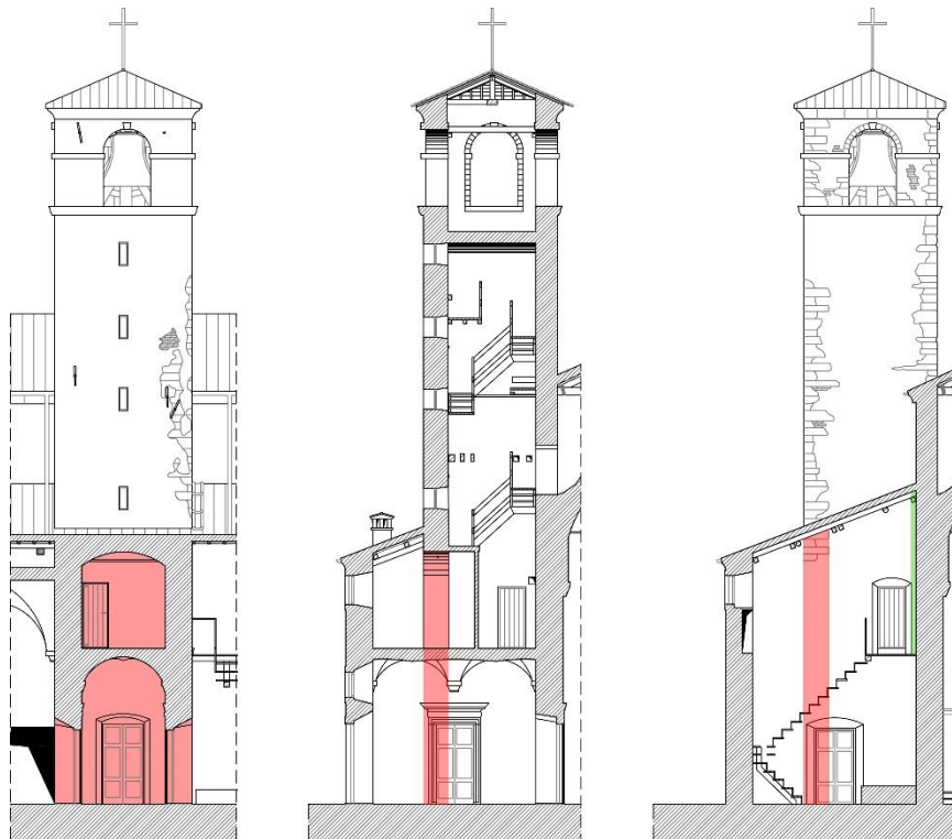
Figura 3.33: schematizzazione delle vulnerabilità del campanile
