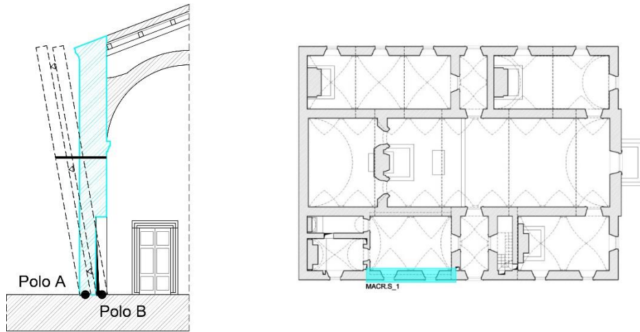
Figura 6.10: Individuazione in pianta e schematizzazione del meccanismo M1.2 nel macroelemento S_1.
