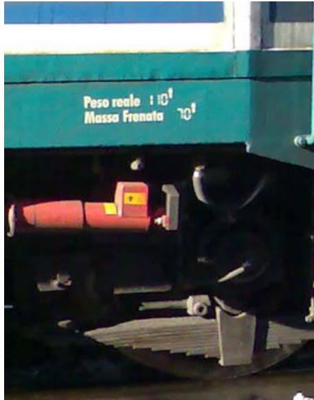
Figura 49 - Esempio di differenza tra massa reale (peso reale) e massa frenata per il calcolo della “percentuale di massa frenante”
