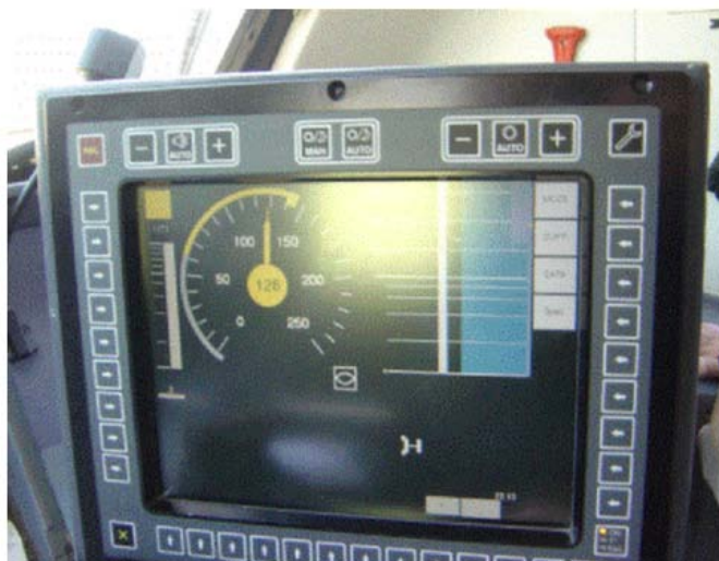
Figura 76 - Fotografia in macchina della Driver Machine Interface
