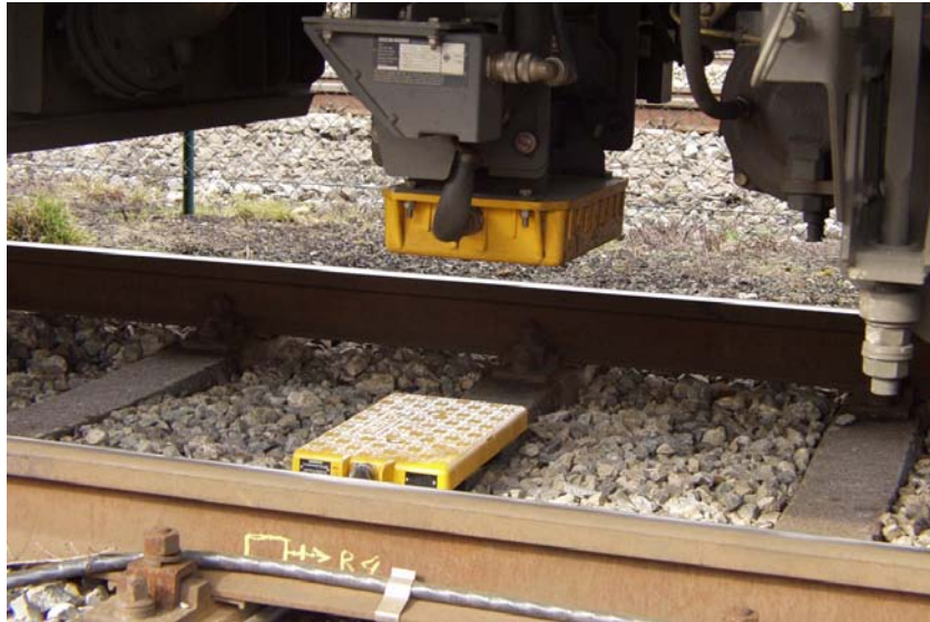
Figura 66 - Trasmissione del telegramma tra Eurobalise e antenna del rotabile
