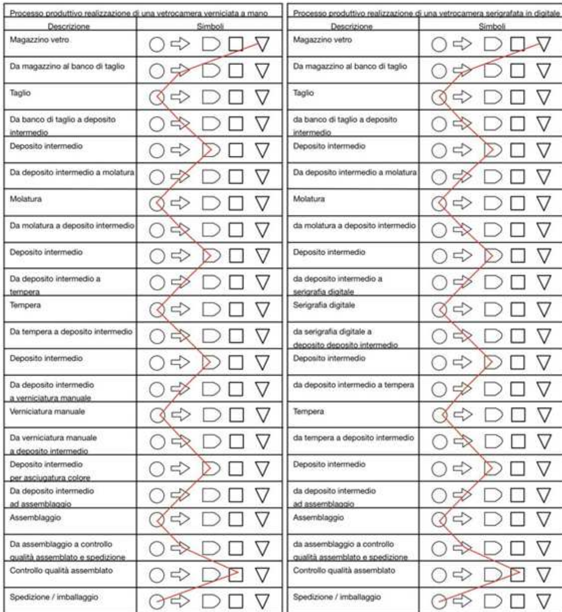
Figura 1.8 - Diagramma tecnologico del processo produttivo.
