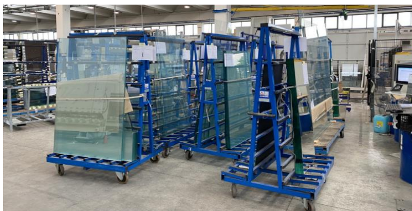
Figura 3.7 - Rappresentazione dei cavalletti nella zona di deposito CMS 2 in attesa di essere sottoposti alla lavorazione di molatura.
