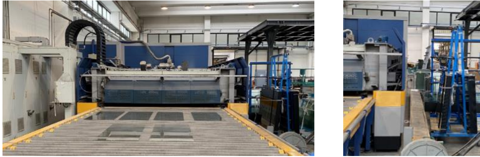
Figura 3.26 – A sinistra è rappresentata la rulliera di ingresso del forno di tempera, a destra la zona di deposito dei vetri temperati.
