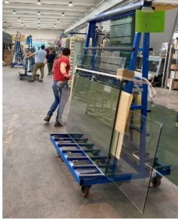
Figura 3.5 - Viene mostrata l'attività di traino della cavalletta con le ruote dall'operatore di taglio dal banco 5 fino all'apposita area di buffer che precede la molatura.
