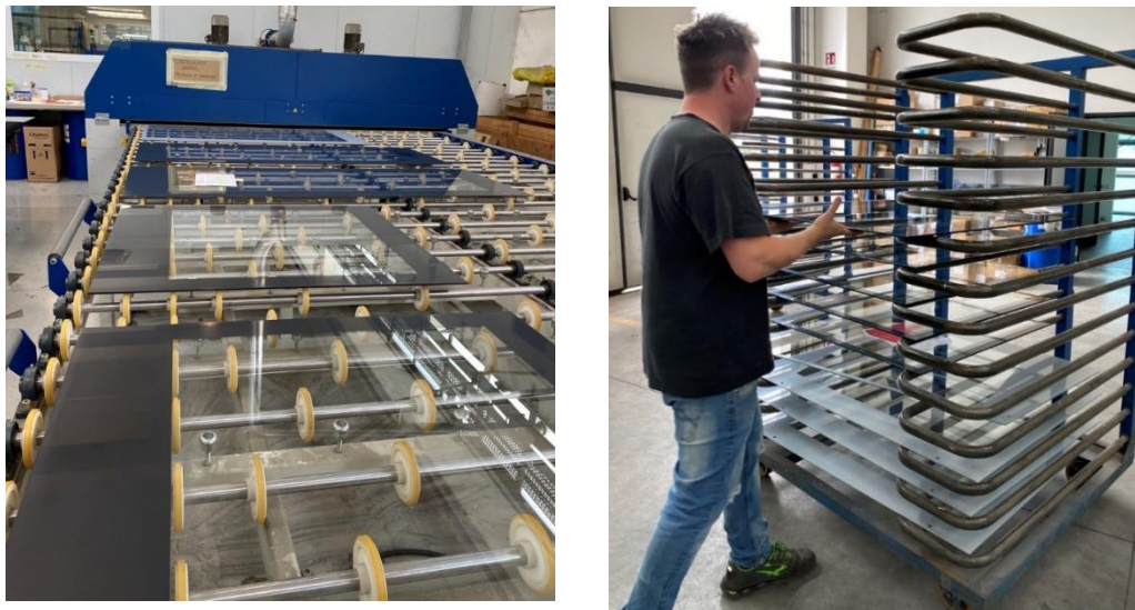
Figura 3.19 – Disposizione dei vetri serigrafati nelle rastrelliere dal basso verso l'alto.
