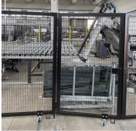
Figura 3.8 - Rappresentazione del cavalletto fisso utilizzato per procedere con il caricamento dei vetri da parte del robot antropomorfo nella macchina di molatura Bilaterale in THERM-IS.
