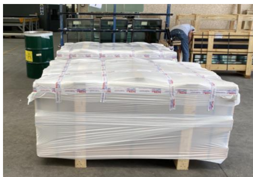
Figura 4.17 – Nell'immagine di sinistra è rappresentata la vetrocamera per cui sta per essere rimosso lo scotch, mentre in quella di destra vediamo le vetrocamere disposte in una cassa di legno, pronte per la spedizione.
