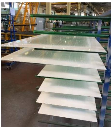
Figura 4.2 – Deposizione dei vetri nella rastrelliera per permettere al colore di asciugarsi.
