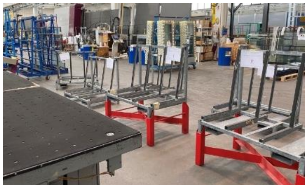
Figura 3.1 - Preparazione dei cavalletti fissi in prossimità del banco di taglio 5.
