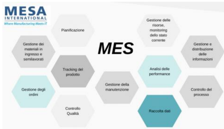
Figura 1.5 - Le 11 funzionalità principali su cui si basa il funzionamento di un sistema MES (MESA International).
