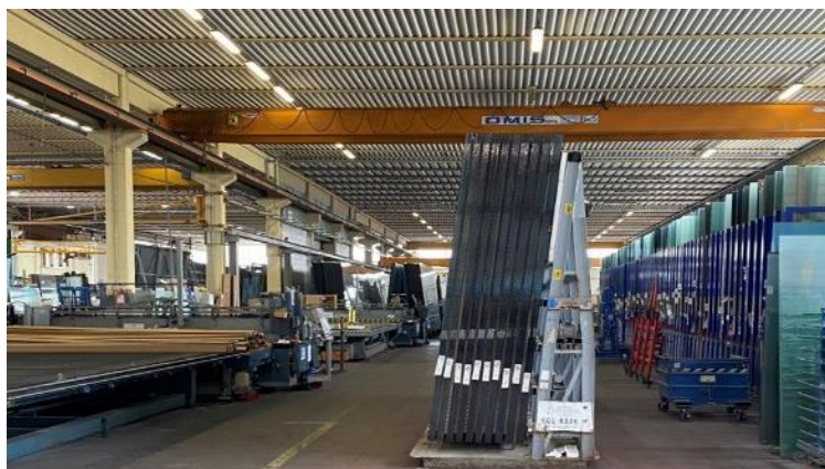
Figura 3.3 – Rappresentazione del cavalletto con cui la THERM-IS riceve la materia prima (la lastra di vetro) dal fornitore, del banco di taglio a sinistra e del deposito materia prima a destra.
