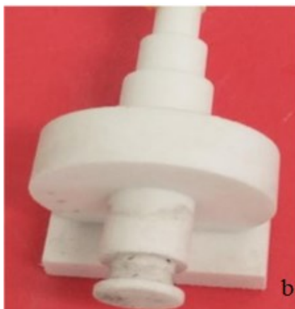
Figura 4.2: (a) Set up sperimentale; (b) Camera anteriore di insufflazione ; (c) Sensore di pressione; (d) Collegamenti idraulici tramite connettore a T rinforzati con elastici e teflon.
