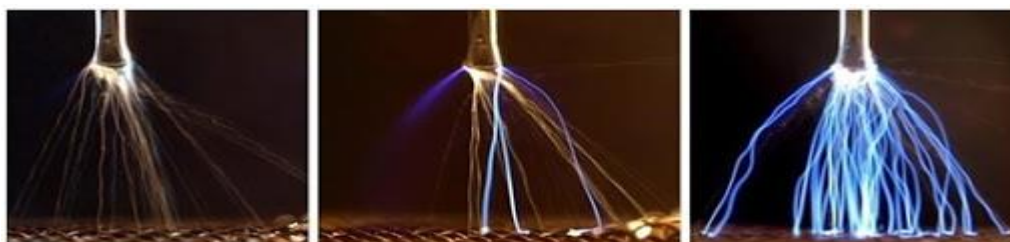
Figura 3.2: Immagini di tipici canali PD (Fonte: http://engineering.electrical-equipment.org/electrical-distribution/types-partial-discharges-gases.html ).
