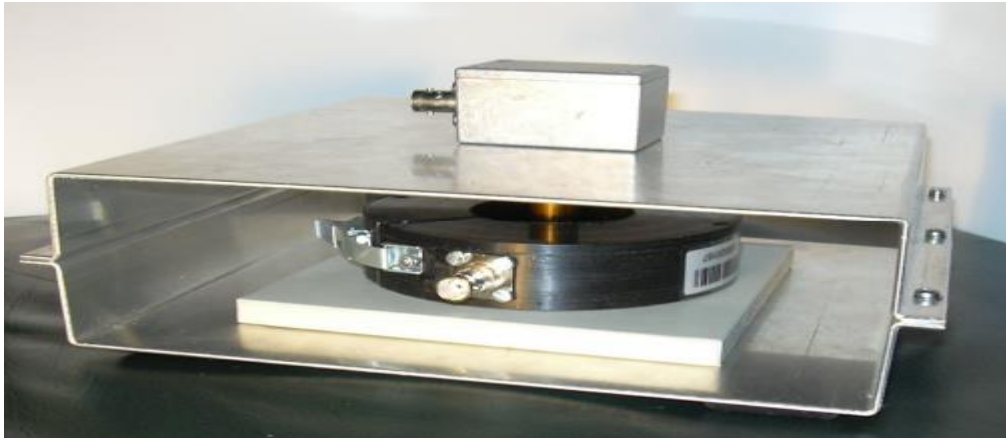
Figura 10.2: Circuito di prova di un HFCT [21].
