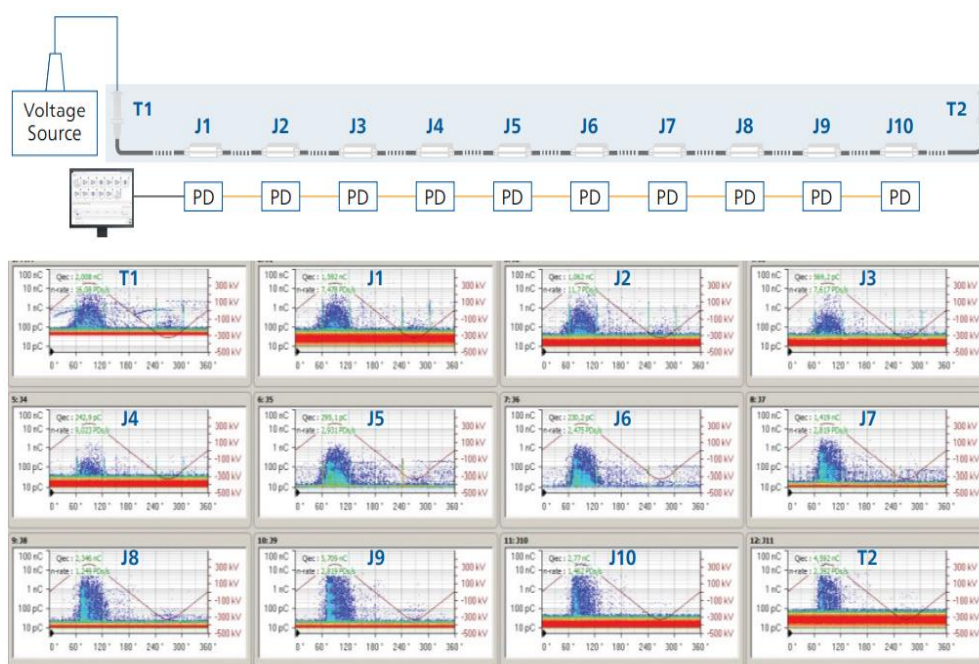
Figura 16.4: HFCT MCT120 con annesso sistema di acquisizione e clustering associato distribuiti lungo il cavo [54].
