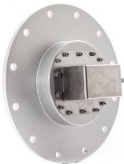
Figura 11.5: Spiral Antenna UHF Trafo prodotta da Techimp [52].
