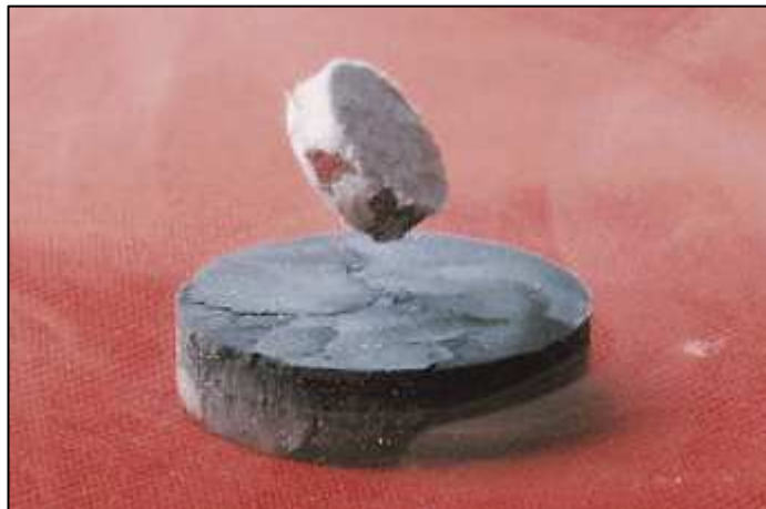
Fig. 5.8.1 - Levitazione magnetica di una pastiglia di materiale superconduttore
