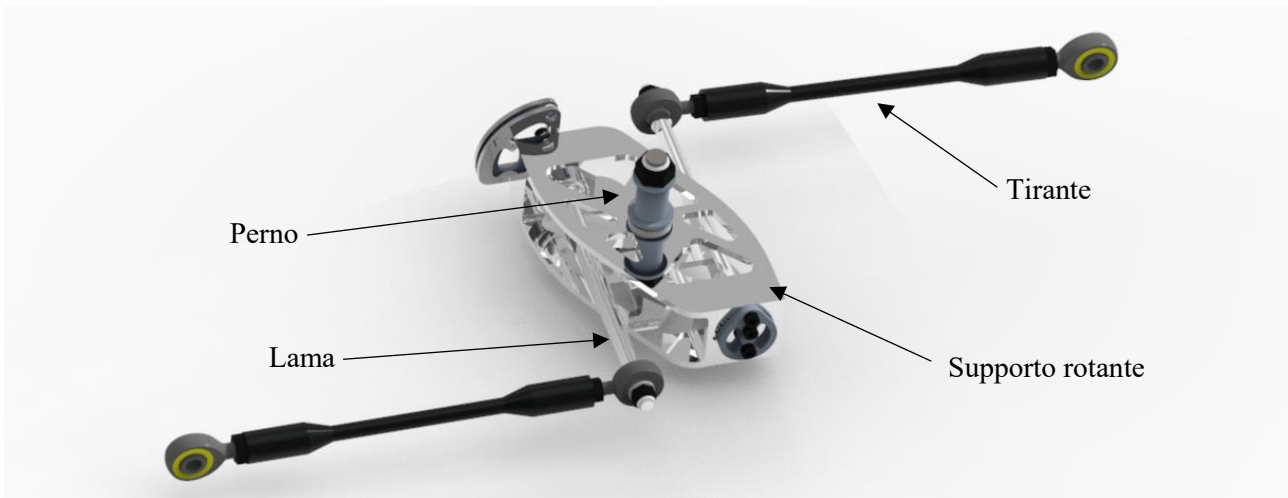
Figura 2.12: barra antirollio anteriore della vettura MG 13.18
