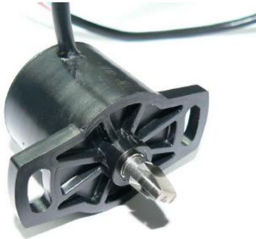
Figura 2.17: potenziometro rotativo montato sulla vettura MG 13.18
