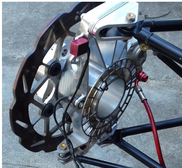
Figura 2.18: ruota fonica montata su un mozzo della vettura MG 13.18
