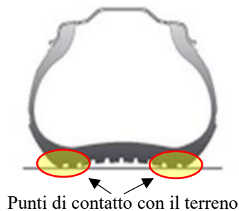
Figura 6.15: deformazione di uno pneumatico gonfiato ad una pressione insufficiente
