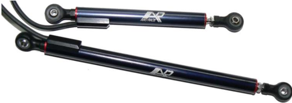
Figura 2.16: potenziometri lineari montati sulla vettura MG 13.18
