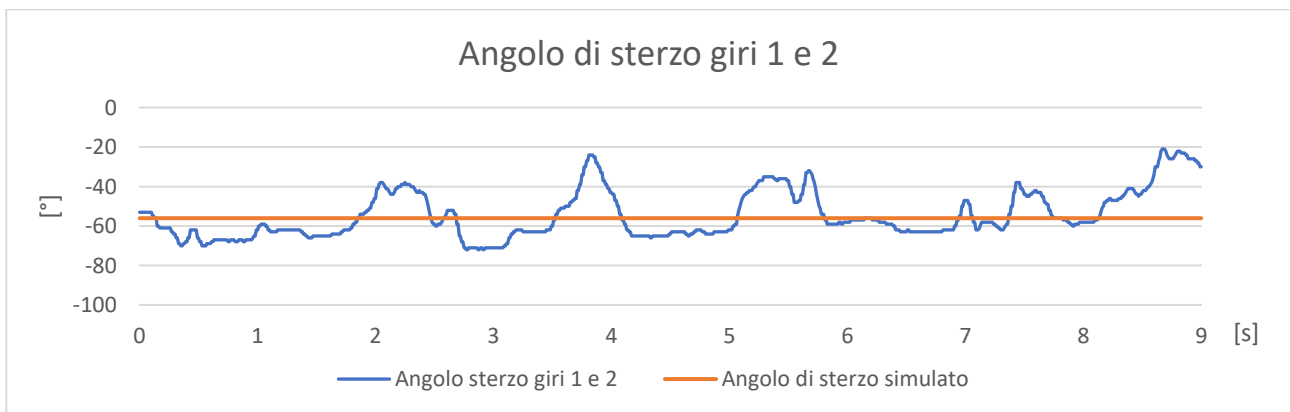
Grafico 5.11: confronto tra l'angolo di sterzo registrato durante i giri 1 e 2 nella prova di skidpad e segnale simulato
