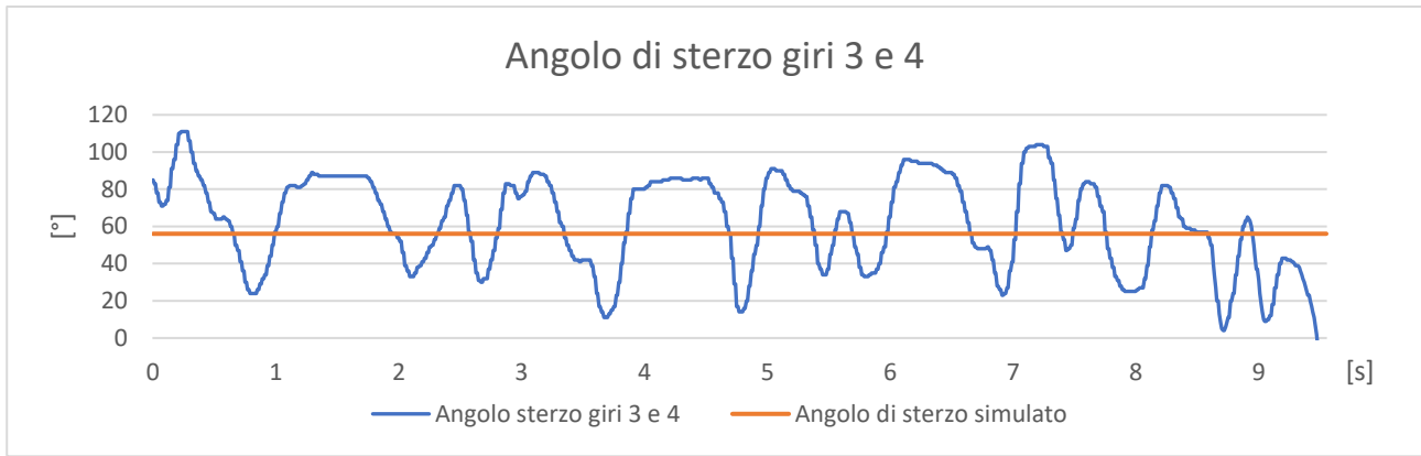
Grafico 5.12: confronto tra l'angolo di sterzo registrato durante i giri 3 e 4 nella prova di skidpad e segnale simulato
