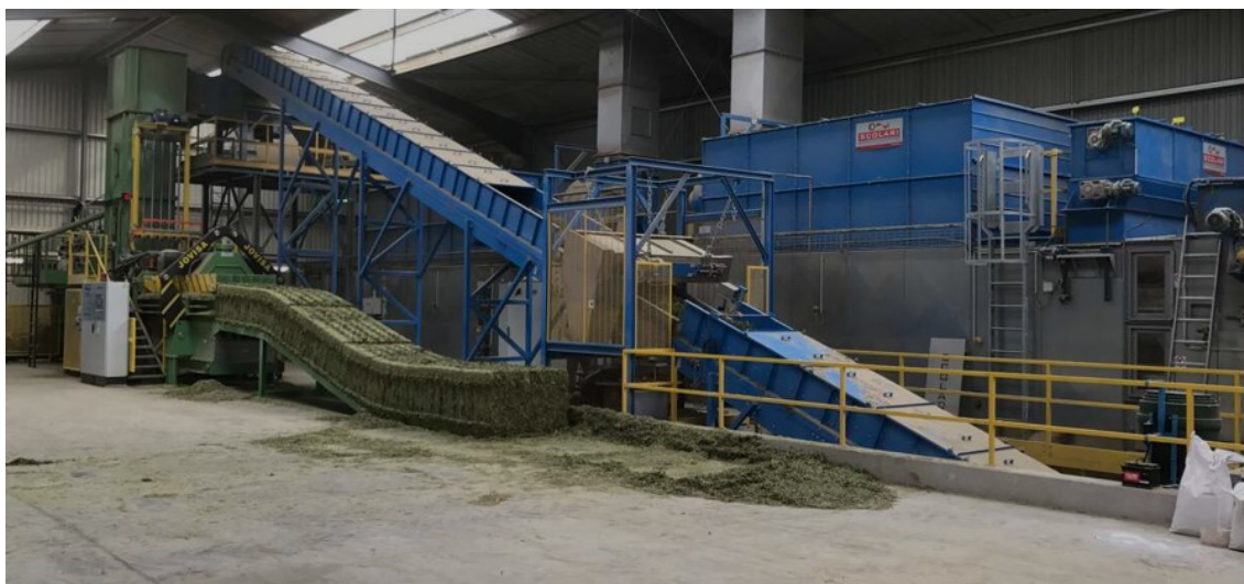
Figura 2.10 - Impianto di disidratazione a bassa temperatura (SCOLARI).
