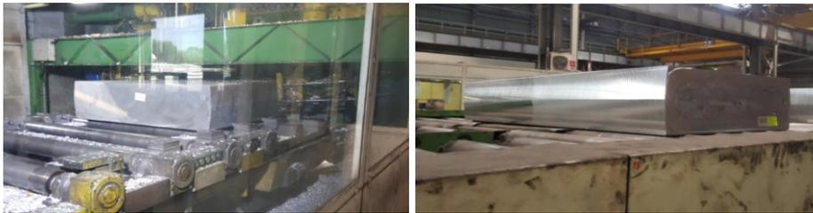
*Figura 1.7: Fase di fresatura della placca (a sinistra) e la placca dopo la fresatura (a destra).*
