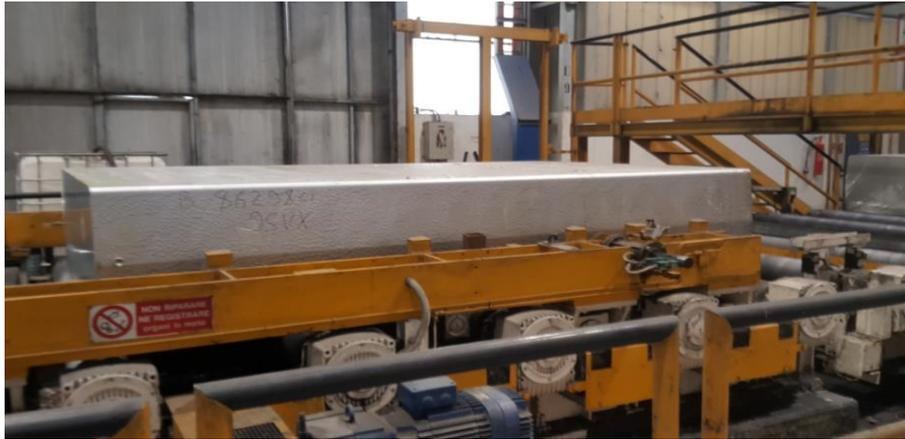
*Figura 1.6: La placca prima della fresatura.*
