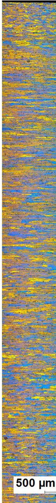
*Figura 4.18: Panoramica fino a 20 mm di spessore della piastra 5083 H111 sp. 60,6 mm laminata a caldo e stirata al 1%.*
