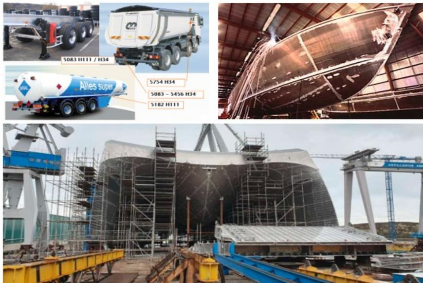
Figura 2.1: Alcuni esempi di leghe di alluminio in applicazioni marine e nel settore dei trasporti.
