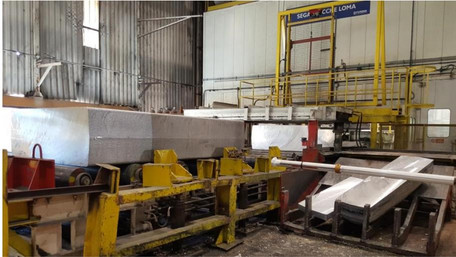
*Figura 1.5: Fase di taglio della testa e della coda.*
