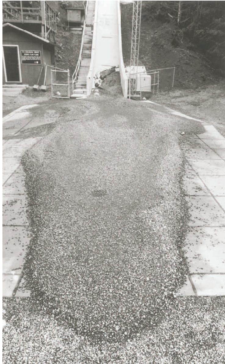
Figura 4.9: Deposito sperimentale (USGS) della colata di detriti, per un flusso saturo. Tipica forma allungata e aree di accumulo dei sassi
