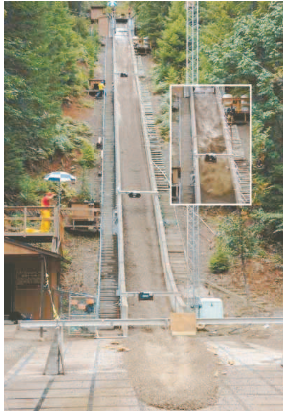
Figura 4.7: Schema del canale (USGS) usata per gli esperimenti, con flussi di acqua satura di materiale
