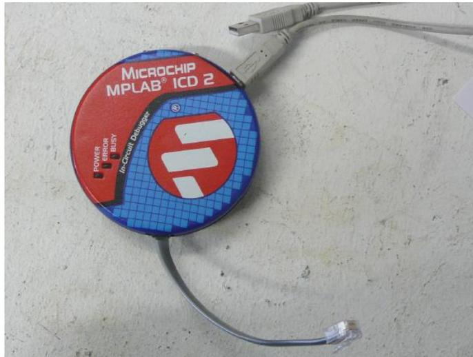
Figura 35 : Utilità di trasmissione del codice dal computer al PIC.
