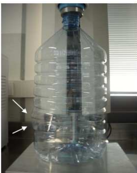
Fig.1 Prova di Top Load sul contenitore di riferimento vuoto: la deformazione avviene sulla zona bassa.
