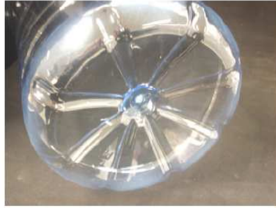
Fig.4 Base del contenitore Siapi priva di deformazioni
