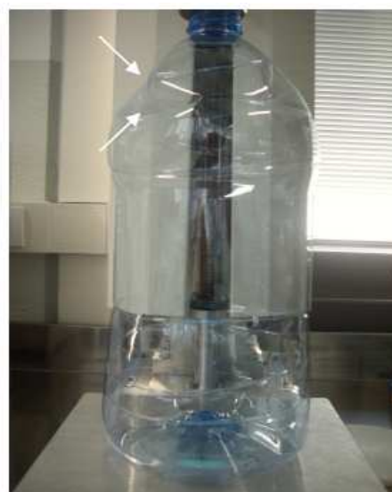
Fig.2 Prova di Top Load sul contenitore Siapi vuoto: la deformazione avviene sulla spalla
