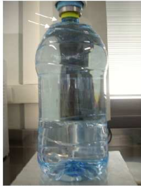
Fig.6 Prova di Top Load sul contenitore Siapi pieno: la deformazione avviene sulla zona alta della spalla
