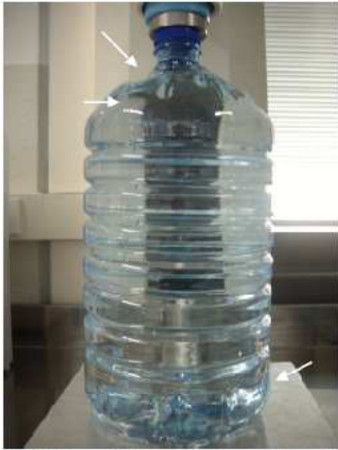
Fig.5 Prova di Top Load sul contenitore di riferimento pieno: la deformazione avviene sulla zona centrale della spalla e alla base
