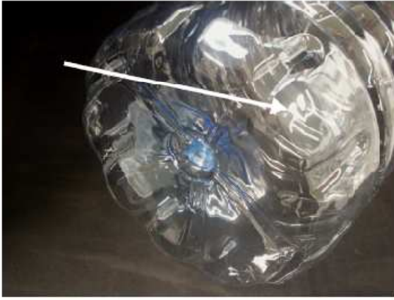
Fig.3 Base del contenitore di riferimento con una deformazione indicata dalla freccia
