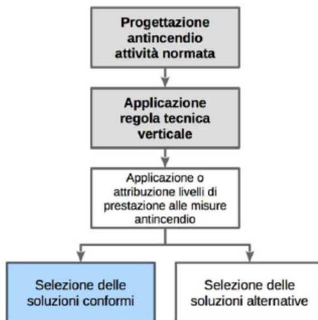
Figura 4.2 _ Schematizzazione della metodologia della progettazione antincendio delle attività normate ( D.M. 3 agosto 2015- Illustrazione G.2.3 )
