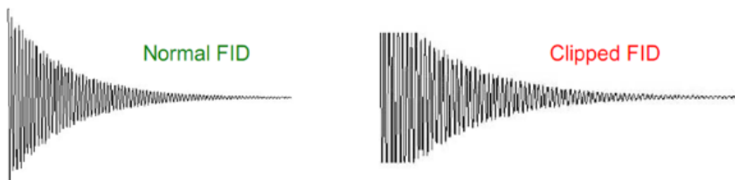
Figura 3.5 (a) FID acquisito correttamente, (b) FID acquisito con eccessiva amplificazione
