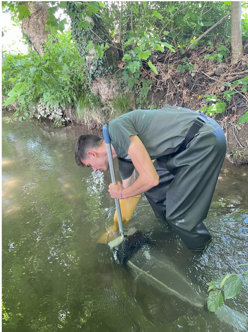
Figura 6: procedimento di campionamento dei macroinvertebrati mediante l'impiego della rete Surber.
