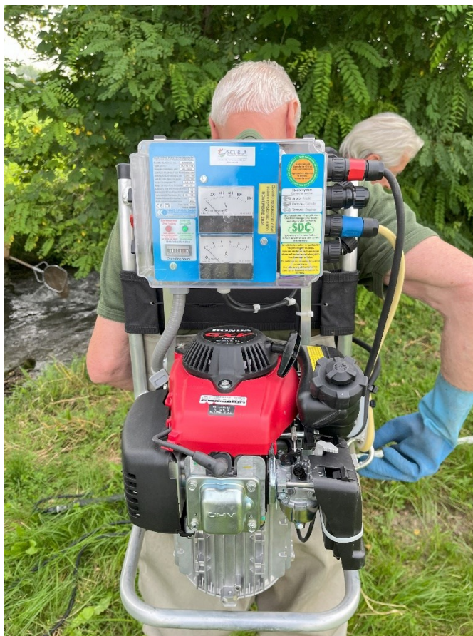
Figura 3: Elettrostorditore impiegato dagli operatori della associazione di pesca “La Sorgente s.m.p.s.” per svolgere la pesca scientifica nelle rogge Uselino e Cumana. Questo strumento permette di scegliere che tipo di corrente utilizzare se continua o ad impulsi. Nel caso di questi campionamenti è stata utilizzata corrente ad impulsi.
