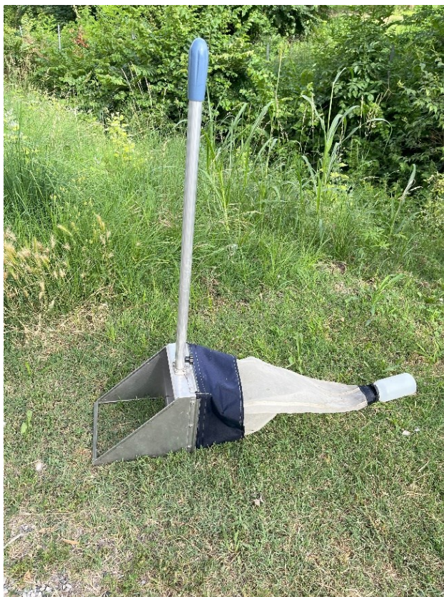
Figura 4: Rete Surber impiegata per i campionamenti dei macroinvertebrati bentonici fluviali.
