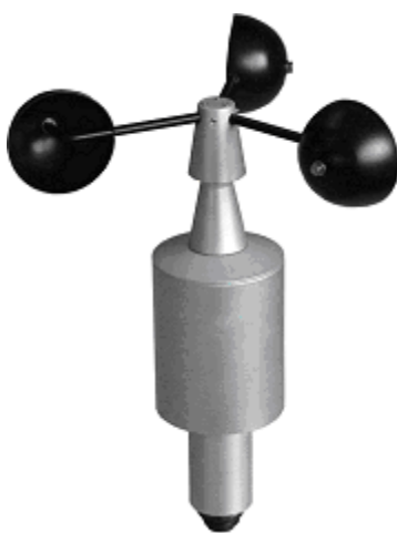
Figura 2.3: Trasduttore di velocità del vento di cui sono dotate le stazioni della RMN
