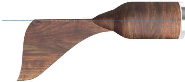
Figura 4.3: Rendering del case contenente il generatore e del timone
