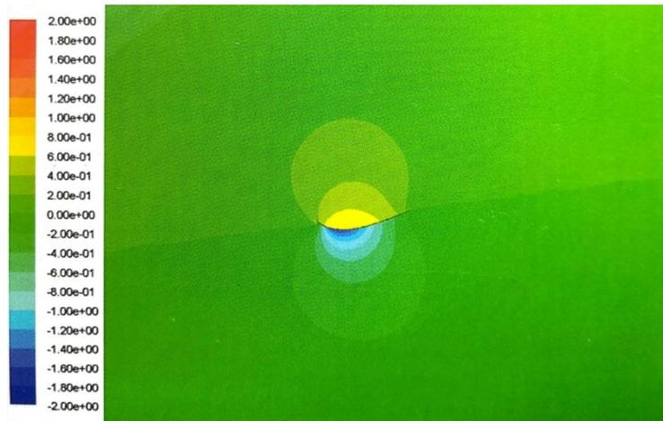
Figura 4.2 mappatura di  $C_p = \frac{p-p_\infty}{\frac{1}{2}\rho V_\infty^2}$  - da [Fossati, 2009]
