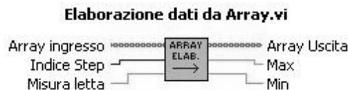
Fig. 3.6 Il subVI per l'elaborazione dei dati contenuti nell'Array.
