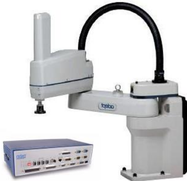
Figura 2.5: Robot SCARA Adept Cobra s600 con controllore Adept MV.
