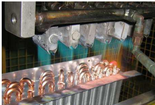
Figura 1.5: Operazione di saldobrasatura delle curve.
