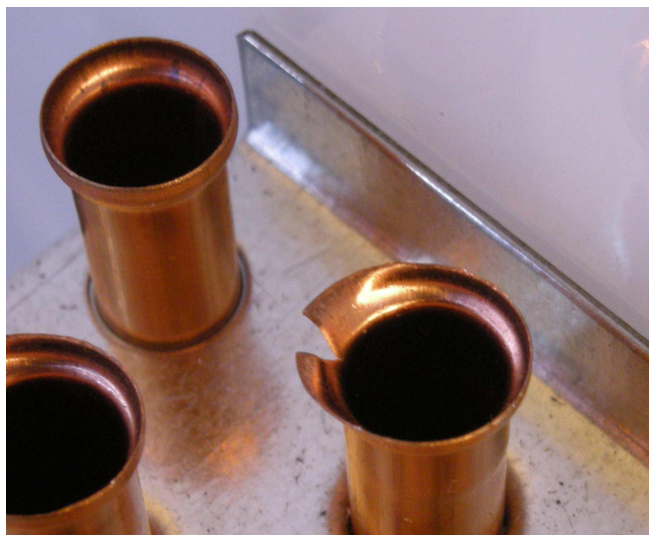
Figura 1.8: Taglio sulla svasatura di un bicchiere.
