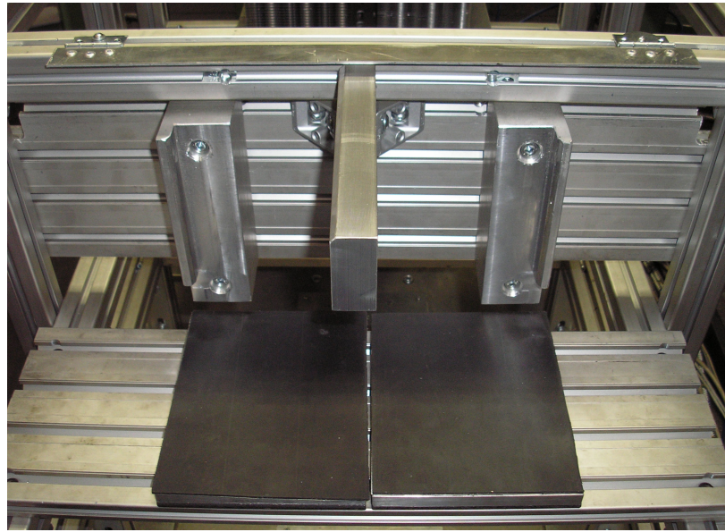
Figura 2.18: Sistema di centraggio della tavola rotante
