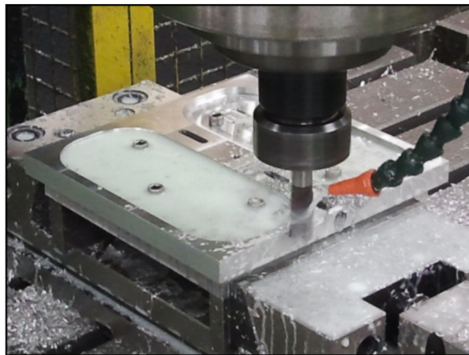
Figura 5. 13 - Esecuzione della fresatura esterna sul componente ST_HH119_002
