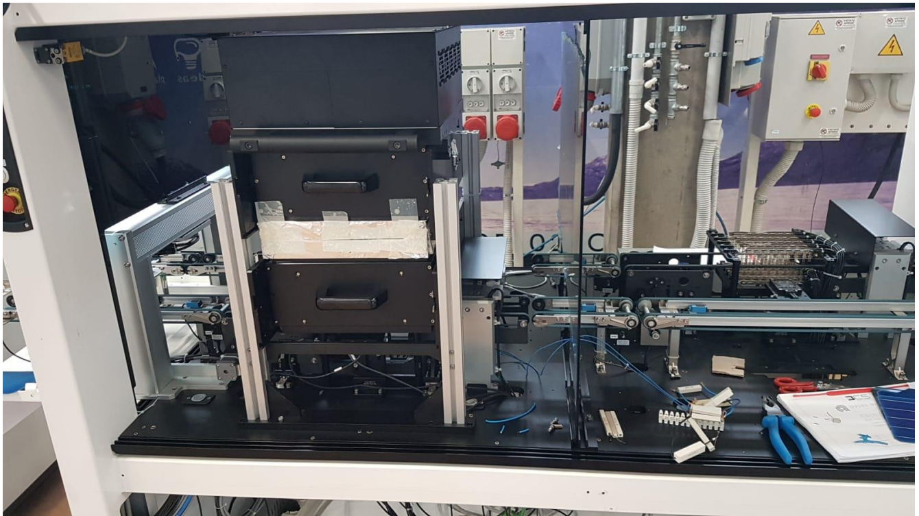
Figura 3.2: modulo contenente il simulatore solare di AppliedMaterials senza pannelli protettivi
