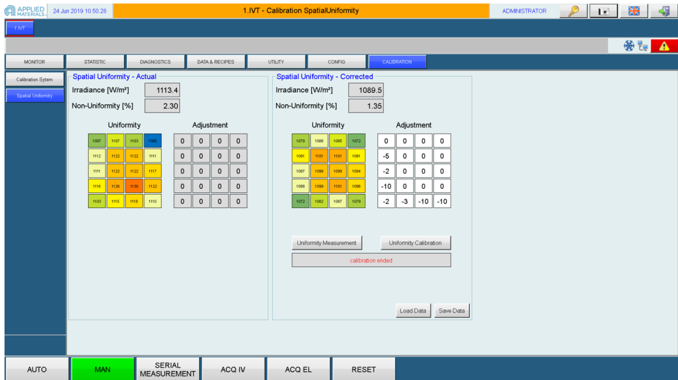
Figura 4.12: interfaccia grafica per l'utente per la funzione di calibrazione di uniformità spaziale
