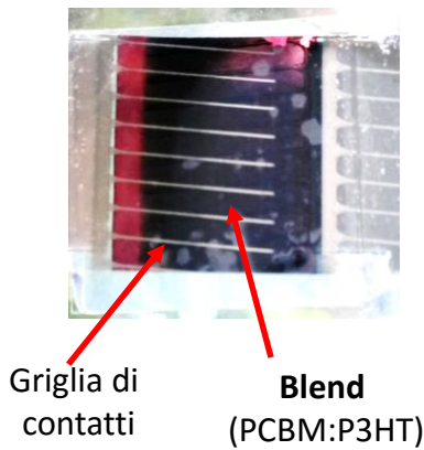
Figura 3.1 Fotografia della cella singola. Si possono vedere i contatti ( front ) e la blend .
