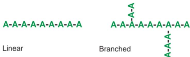
Figura 3.2 - Struttura schematizzata di un polimero lineare (a destra) e di uno reticolato (a sinistra).
