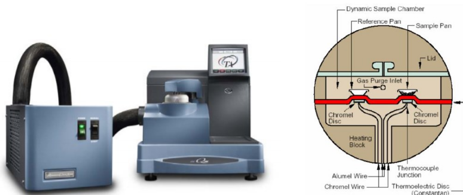
Figura 6.1 - DSC Q200 TA utilizzata (a sinistra) e dettaglio della piattaforma termoelettrica dove vengono inseriti i campion (a destra).
