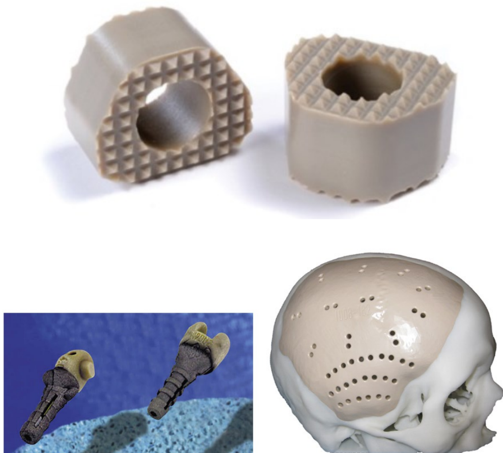
Figura 3.13 - Esempi di applicazioni biomedicali per il PEEK: in alto, esempi di vertebre per interventi di fusione spinale in PEEK, in basso a sinistra, impianti sostitutivi per le articolazioni delle dita, e a destra, sostituzione parziale dell'osso del cranio (Kurtz "The PEEK Handbook").
