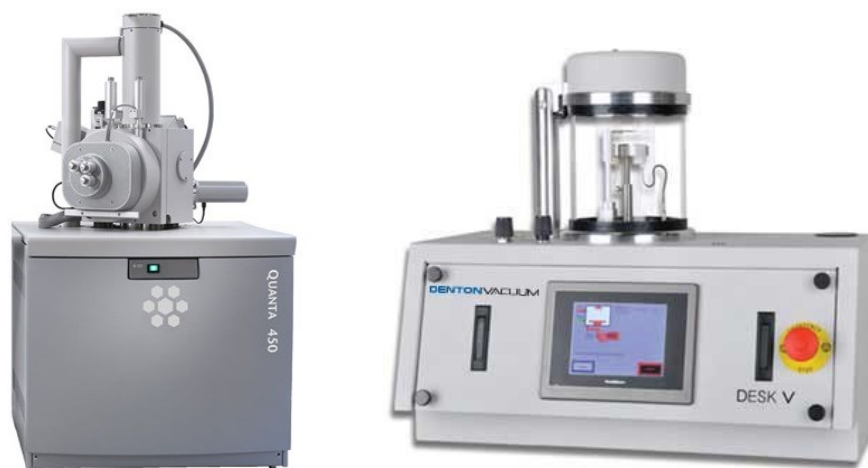
Figura 6.12 – Microscopio elettronico a scansione FEI Quanta 450 SEM, a destra, macchina Denton Vacuum, dispositivo per il rivestimento a freddo di materiali non conduttivi, a sinistra,.
