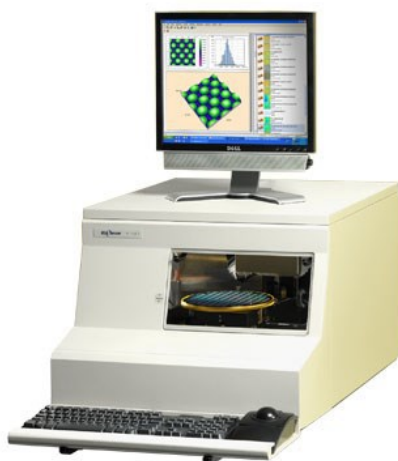
Figura 2. 3: Profilometro a stilo KLA-Tencor P-16+
