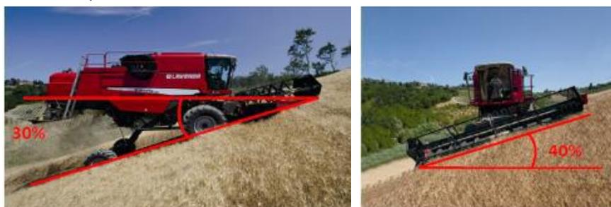
Figura 4.4 – modello AutoLivellante
