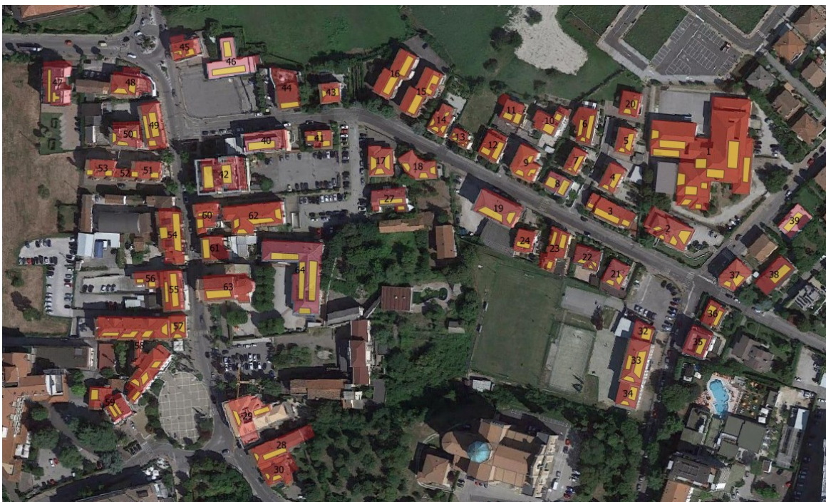
Figura 5.5 - Immagine satellitare con superfici in pianta degli edifici (rosso) e del fotovoltaico (giallo)
