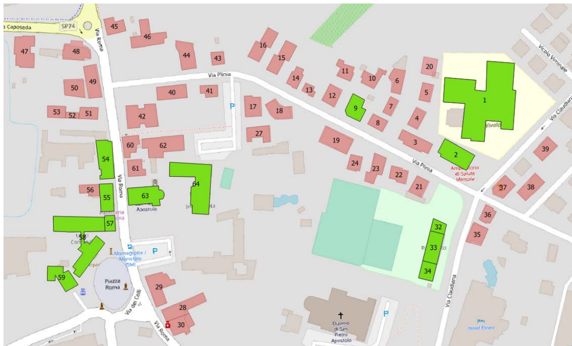
Figura 5.6 - Edifici collegati alla rete di teleriscaldamento per un fabbisogno termico complessivo di 1500MWh
