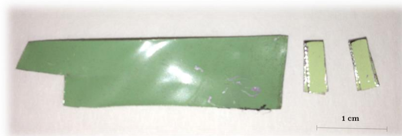
Figura 4.24 : Fotografia del colore del campione prima e dopo il processo di de-coating con velocità di riscaldamento di 5°C/min e temperatura massima di 570°C in aria.
