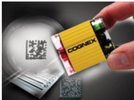
Figura 4.2 : la ditta Cognex nella sua gamma di lettori di codici a barre fissi e mobili utilizza lenti liquide. Qui in figura è rappresentato un esempio di lettore mobile.
