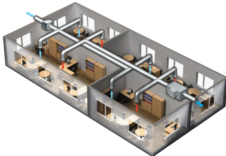
Figura 1: Rappresentazione di un sistema di condizionamento HVAC
