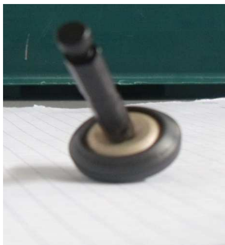
Figura 4.9. Otturatore trattato riporta i segni del vetro liquido rilasciato dalla sede anch'essa trattata.
