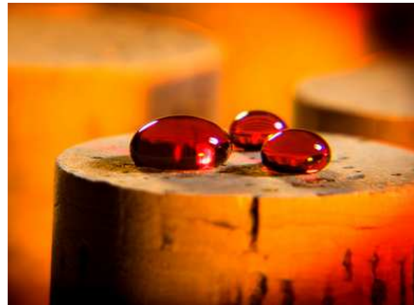
Figura 2.2 Repellenza allo sporco dimostrata da una superficie trattata al Vetroliquido Nanopool®
