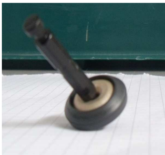
Figura 4.7. Otturatore presenta sulla superficie delle anomalie più precisamente un bordo lucido. Questo proprio nella zona in cui la superficie è tenuta in maggior pressione dalla molla contro la sede di chiusura
