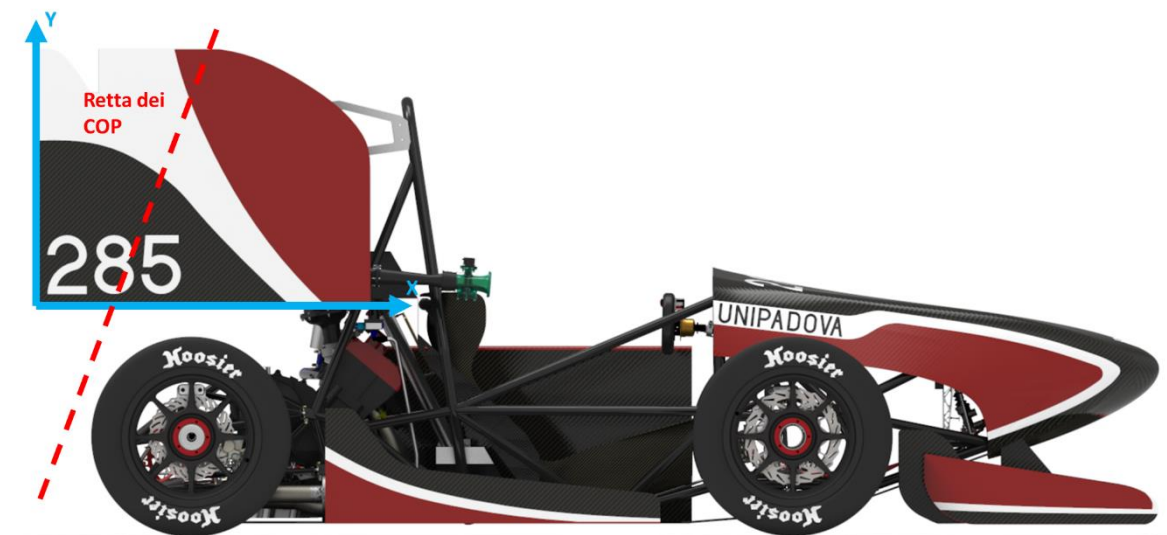
Figura A.1: Linea dei C.O.P. dell'ala anteriore
