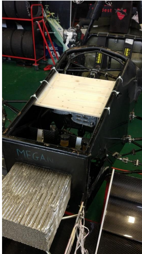
Figura 2.40: Fissaggio della tavola porta-centraline a telaio
