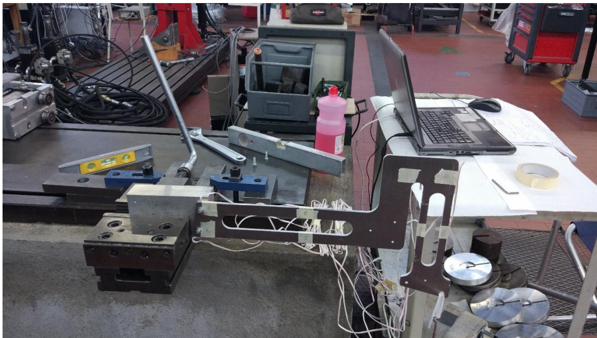
Figura 3.3: Componente sollecitato a downforce
