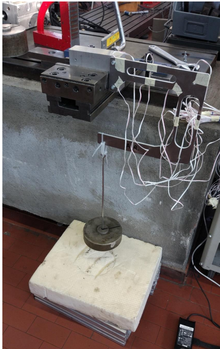
Figura 3.5: cella di carico A.R. sollecitata a downforce
