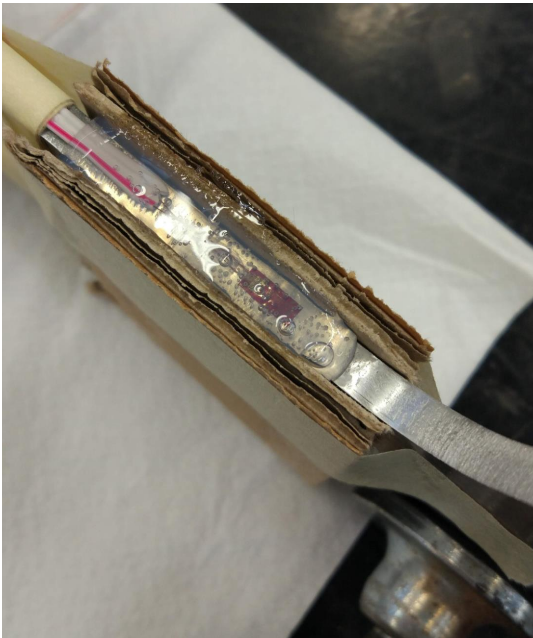
Figura 2.31: Strato protettivo di silicone sopra all'estensimetro incollato
