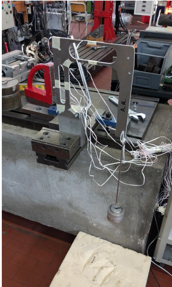
Figura 3.8: cella di carico A.R. sollecitata a drag
