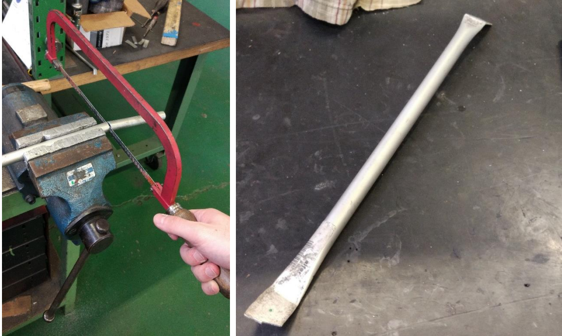
Figura 2.43: Taglio del tubicino di alluminio (a sinistra) e tubicino piegato (a destra)
