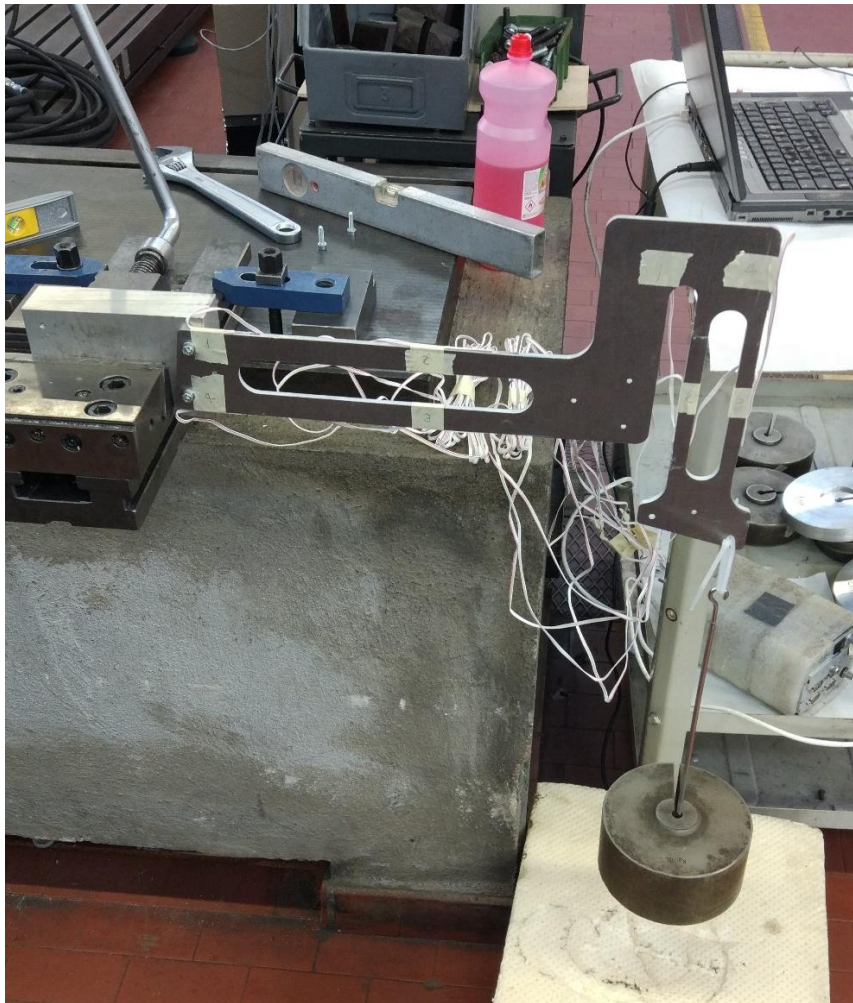
Figura 3.12: cella di carico P.R. sollecitata a downforce
