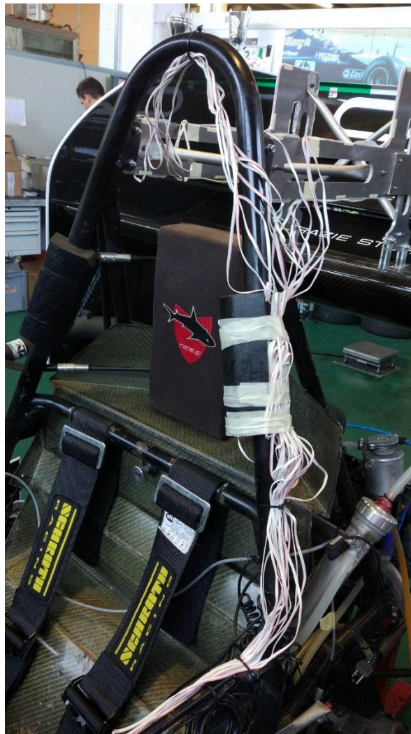
Figura 4.50: Percorso dei cavi provenienti dalle celle di carico posteriori
