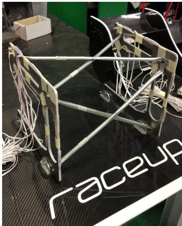
Figura 2.44: Struttura di supporto anteriore con montati i tubicini a "X"
