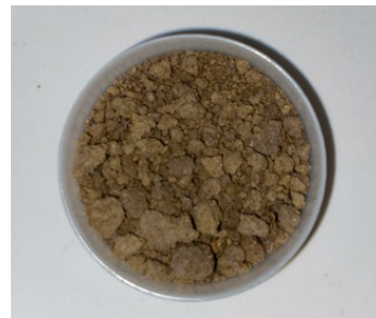
Figura 3.22: campione di suolo per la misura con il WP4.
