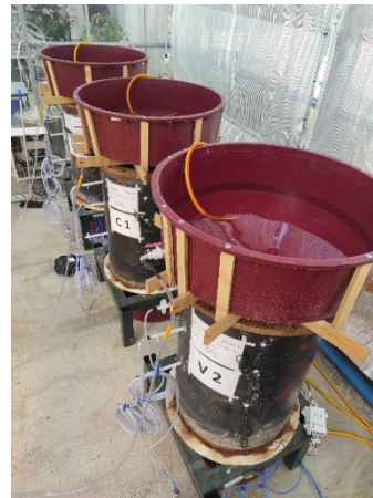
Figura 3.17: simulazione di pioggia.
