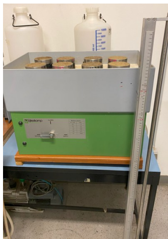
Figura 3.20: cassetta tensiometrica con i campioni di suolo indisturbati al suo interno.
