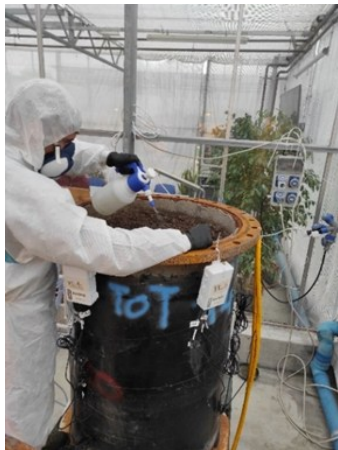
Figura 3.16: trattamento dei lisimetri con fluopicolide.
