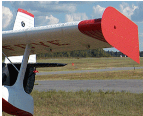
FIGURA 4.12 – Esempio reale di geometria dell'end plate. Immagine tratta da [36]
