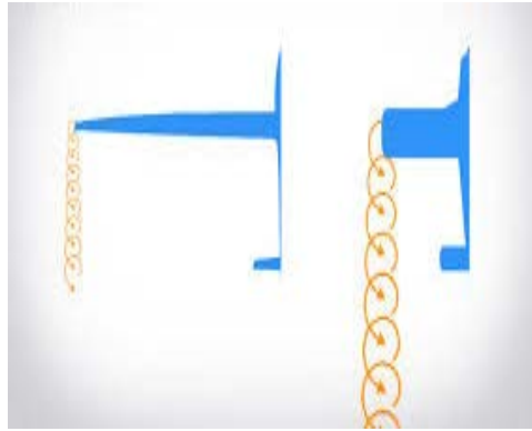
FIGURA 1.6 – Effetto del rapporto d'aspetto sul vortice d'estremità alare. Immagine tratta da [22]
