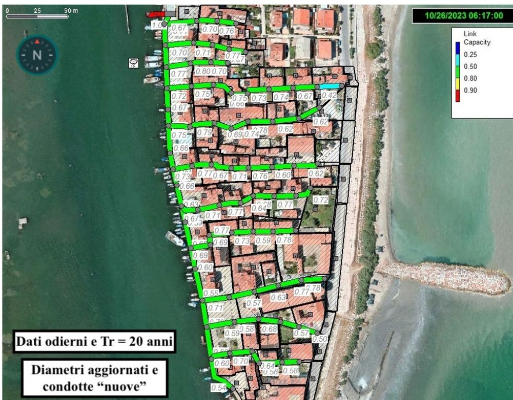
Figura 5.2 – Gradi di riempimento (%) a seguito della modifica dei diametri
