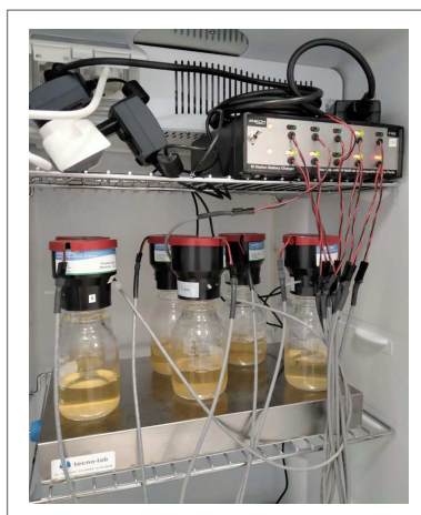
Figura 3.2. Bottiglie usate per i saggi fermentativi. Le prove di fermentazione sono state realizzate in 175 ml di mosto in bottiglie collegate al sistema ANKOM RF , provviste di tappi in grado di rilevare la pressione.
