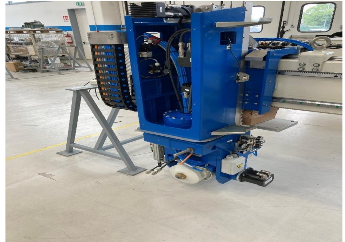
Nelle fasi successive vengono assemblati il ponte e infine il monoblocco è allestito per ottenere la macchina completa pronta per essere spedita.
