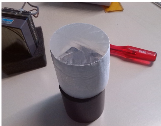
Figura 2.6: L'EJ-299-33 danneggiato; si nota la deformazione e l'opacità che lo rendono inutilizzabile.
