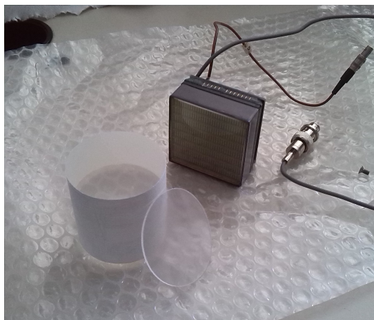
Figura 2.1: L' EJ-299-33 con la pad adesiva di EJ-560 e il PMT.
