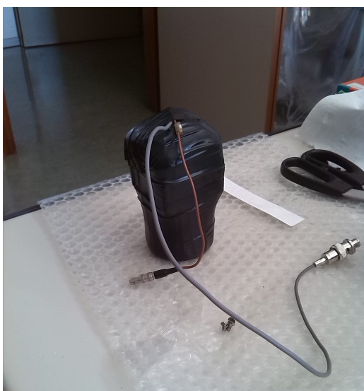
Figura 2.3: Il rivelatore con EJ-299-33 completo.
