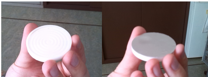
Figura 2.2: L'EJ-420; si può notare uno strato di alluminio per impedire la fuoriuscita della luce e la componente plastica trasparente per il collegamento.
