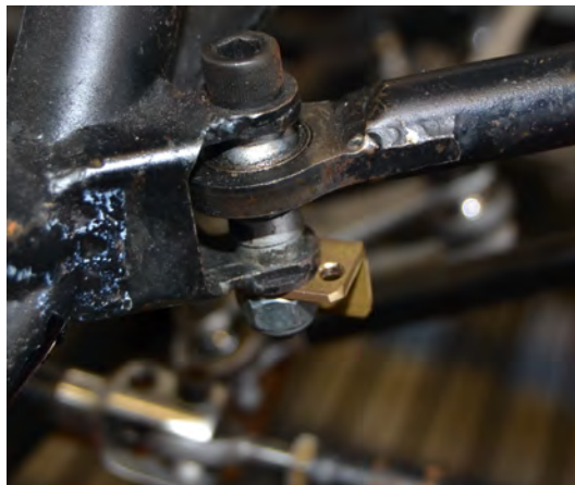
Figura 6.16: Supporto per filo montato sull'attacco delle sospensioni.
