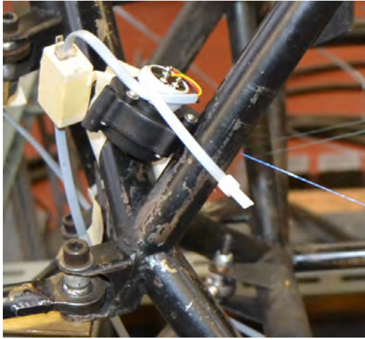
Figura 6.88: Fissaggio dei sensori sul telaio.
