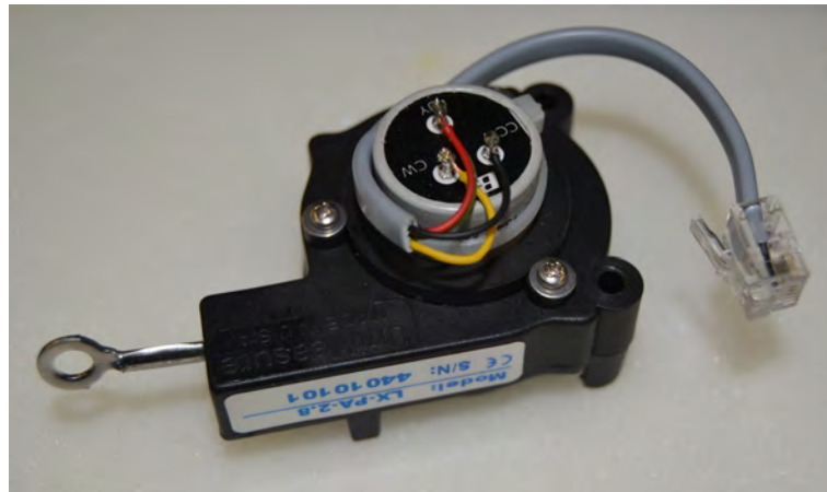
Figura 6.14: Potenziometro a filo utilizzato nelle prove.
