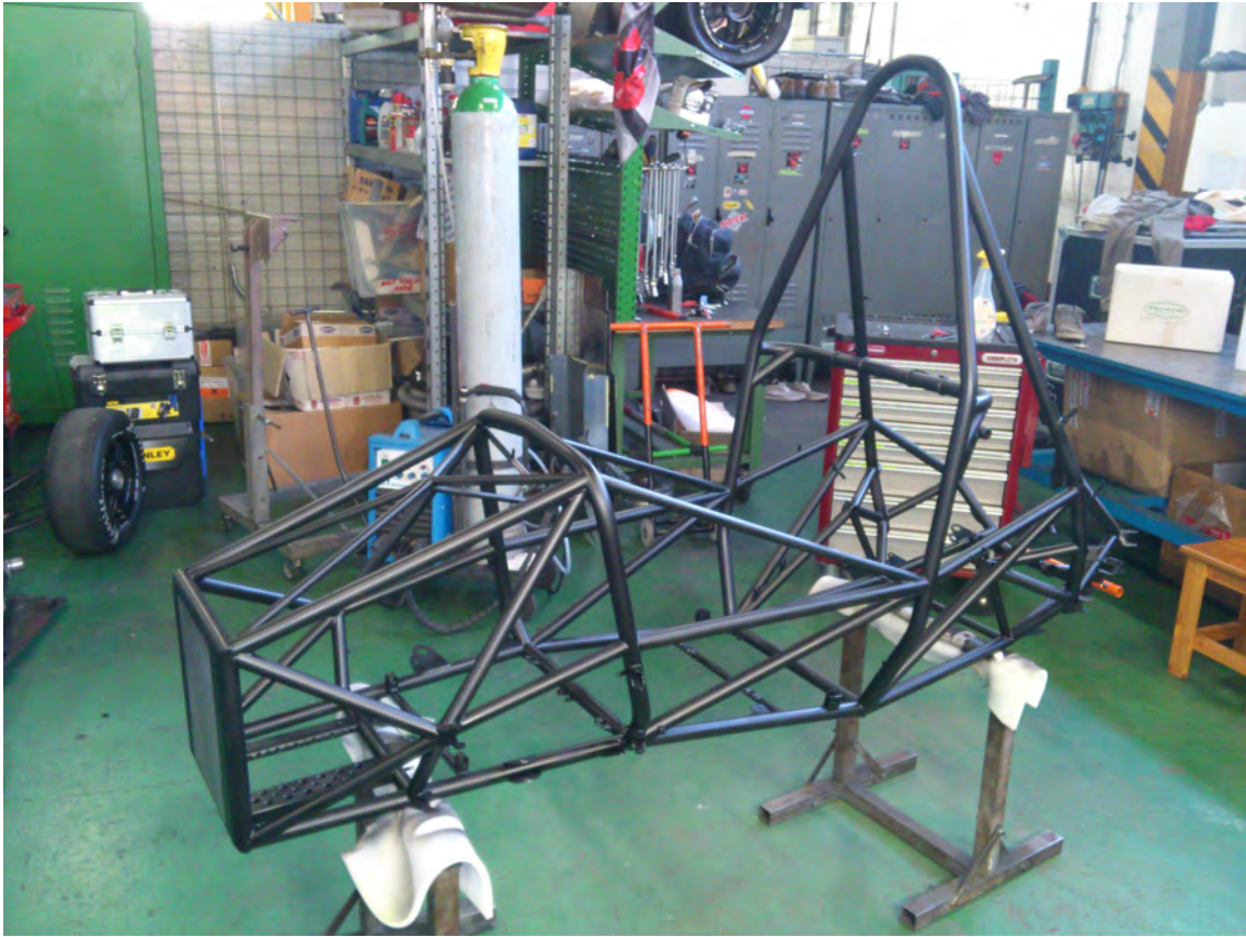
Figura 3.24: Telaio finito e verniciato.
