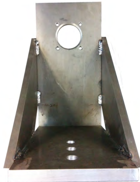
Figura 6.4: Supporto posteriore realizzato in laboratorio.
