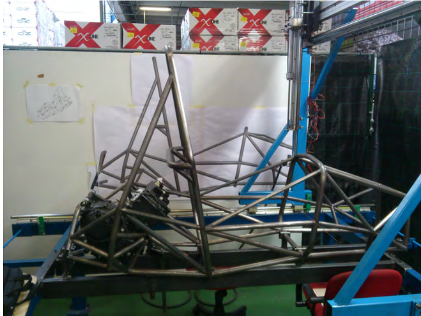
Figura 3.22: Completamento del puntamento del telaio.
