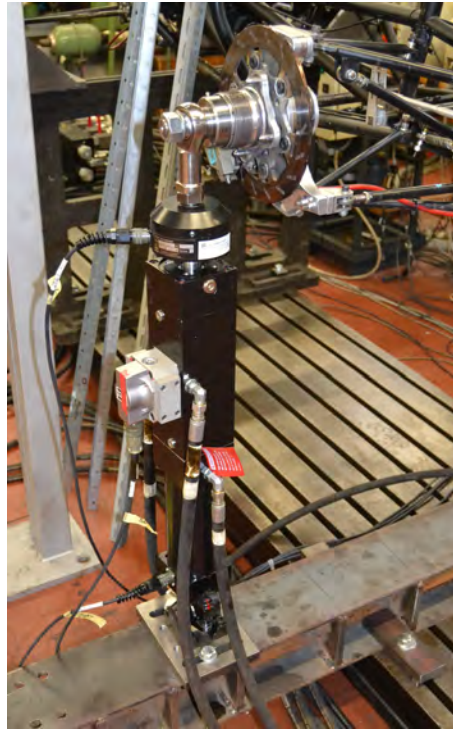
Figura 6.9: Martinetto installato sul banco.
