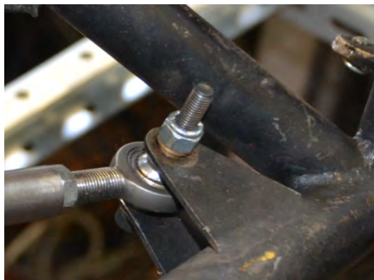
Figura 6.86: Attacco a telaio delle sospensioni.
