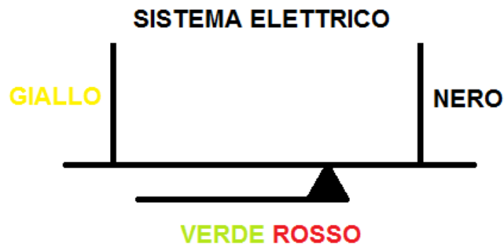
Figura 6.22: Schema elettrico per il collegamento del potenziometro.
