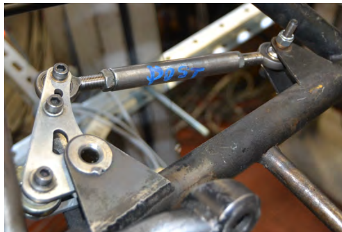
Figura 6.10: Barra in acciaio che sostituisce gli ammortizzatori.
