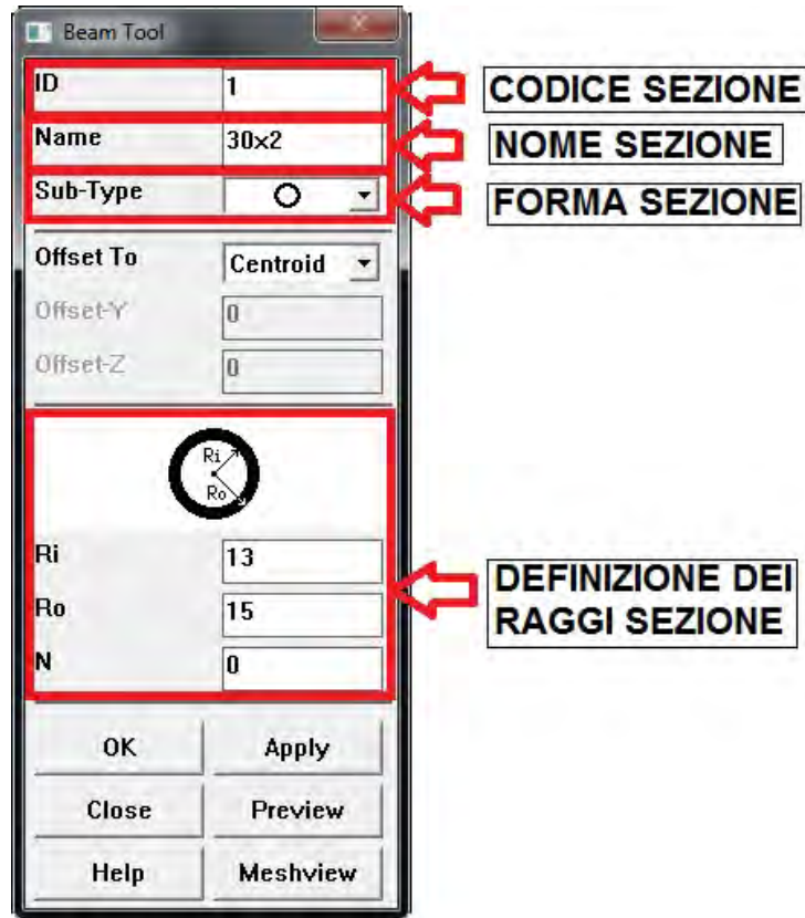
Figura 4.13: Inserimento dei dati della sezione tubo.
