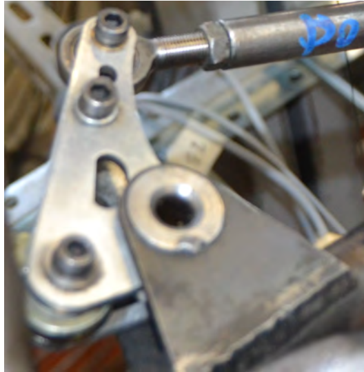
Figura 6.85: Dettaglio dello snodo squadretta.
