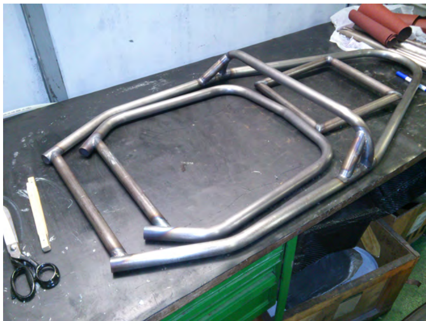
Figura 3.15: Main Hoop, Front Hoop e Bulkhead saldati.
