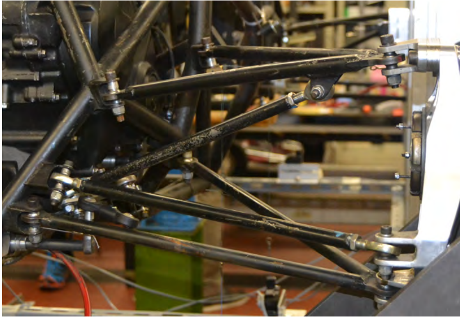
Figura 6.83: Braccetti della componente delle sospensioni posteriore destra, si possono vedere gli uniball e gli attacchi a telaio e sul portamozzo.
