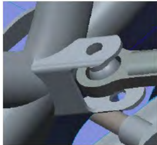
Figura 5.36: Attacco delle sospensioni MG0914.
