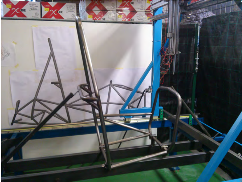
Figura 3.16: Realizzazione della parte Side Impact.
