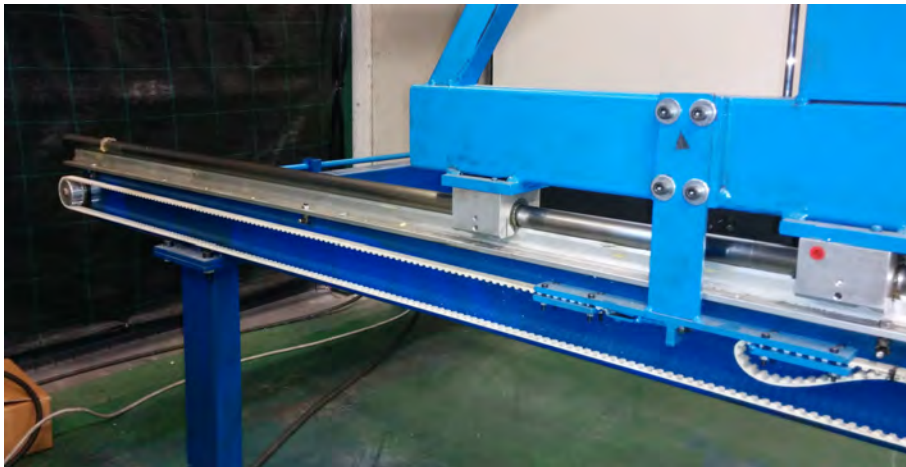
Figura 3.5: Cinghie laterali per bilanciamento dei supporti verticali.
