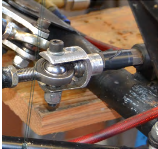
Figura 6.11: Boccole per il bloccaggio dello sterzo.
