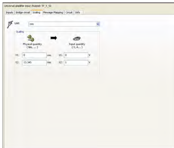
Figura 6.17: Impostazione del fattore di taratura dei sensori.
