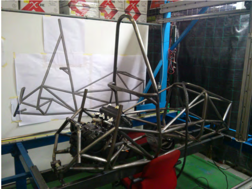
Figura 3.20: Realizzazione della parte posteriore sinistra.
