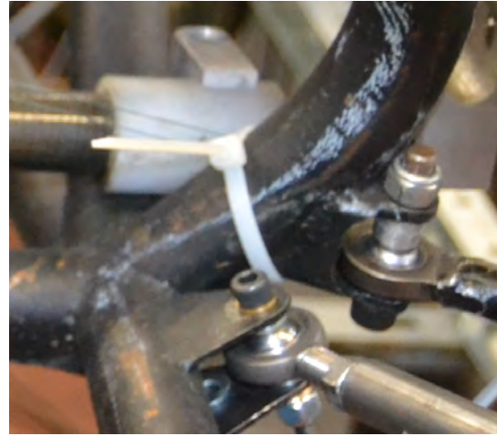
Figura 6.89: Fissaggio del cavo sulla struttura del telaio.
