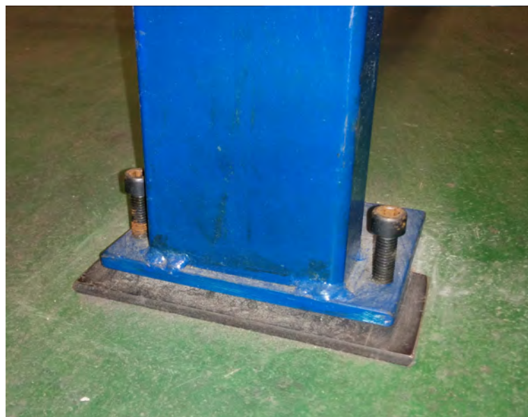
Figura 3.3: Viti per la regolazione del piano del banco.
