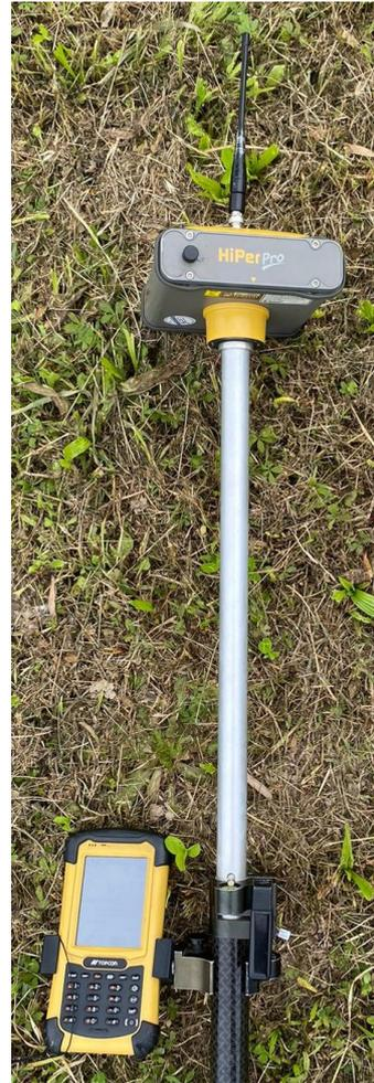
Figura 17: Ricevitore GNSS
