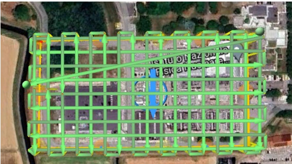
Figura 18: Area per i voli a doppia griglia del modello 3D
