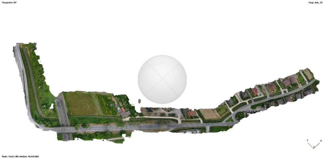
**Figura 24: Superficie interpolante la nuvola di punti (*mesh*)**
