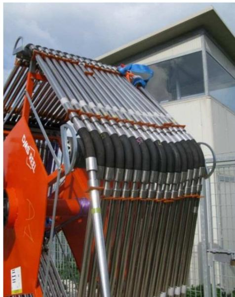
Figura 4.28 – Catena inclinometrica DMS 2D avvolta su di una spira, pronta per l'installazione.
