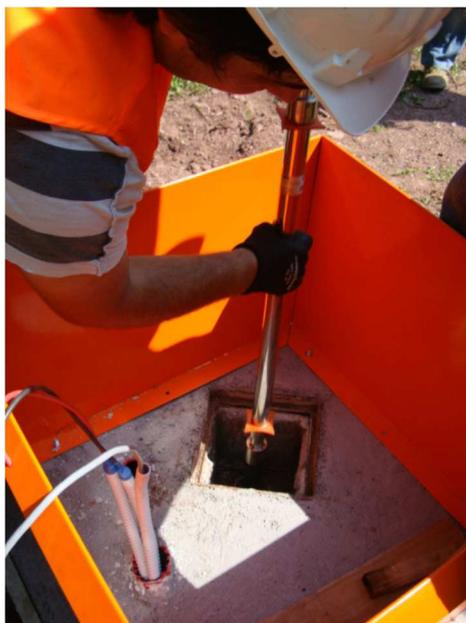
Figura 4.29 – Installazione della colonna DMS presso il tubo inclinometrico IN3-N della frana di Idro. Arpa Lombardia, 2011)
