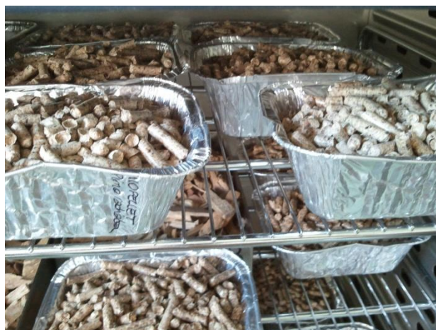
Figura 6.4.13 Le vaschette con il pellet inserite in stufa a 105°C per l'essiccazione
