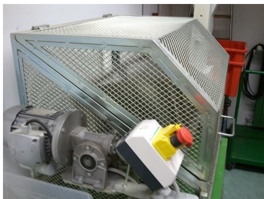
Figura 6.4.10 Le vaschette metalliche vengono caricate nel telaio rotante per la prova di durabilità
