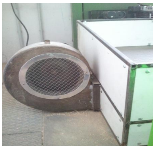
Figura 6.3.14 Sistema di raffreddamento con il telaio in legno
