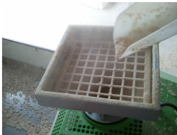
Figura 6.3.10 Alimentazione manuale della pellettatrice
