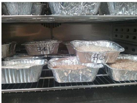
Figura 6.2.2 Le vaschette con i diversi materiali poste in stufa a 105°C per l'essiccazione
