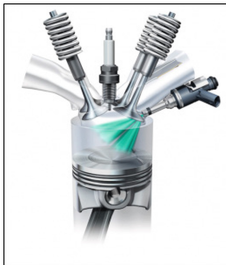
Figura 1.1. Iniezione diretta del carburante all'interno del cilindro.
