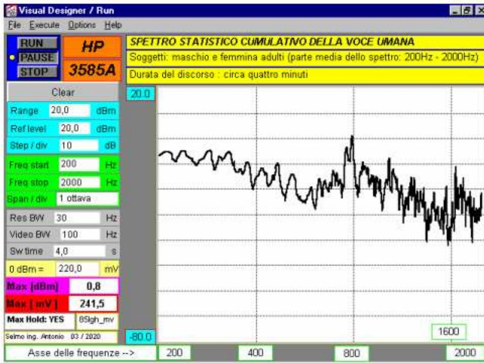
Fig.6 analisi estesa sulla seconda decade tra 200 Hz e 2000 Hz [4].
